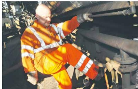
Routiniert trennt Winfried Kagelmacher nach der Leerung den Befüllungsschlauch per Tritt vom Kesselwagen.
