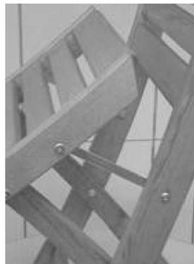
Der Klappmechanismus eines Klappstuhls ist so konstruiert, dass die Finger des Benutzers zwischen Sitzfläche und Klappmechanismus eingeklemmt werden können. Dies kann zu einer Fraktur oder sogar zum Verlust eines oder mehrerer Finger führen.
