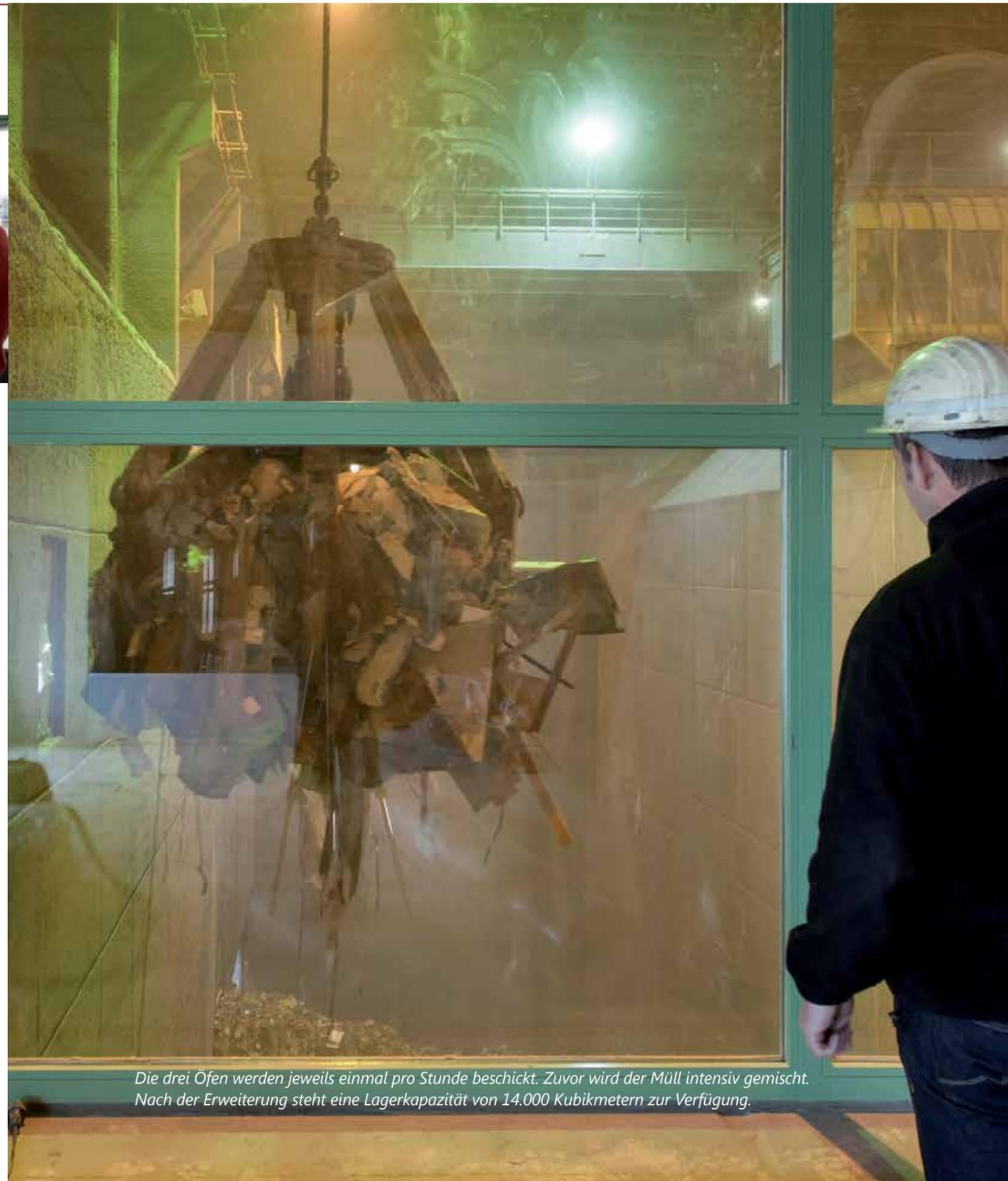
Die drei Öfen werden jeweils einmal pro Stunde beschickt. Zuvor wird der Müll intensiv gemischt. Nach der Erweiterung steht eine Lagerkapazität von 14.000 Kubikmetern zur Verfügung.
