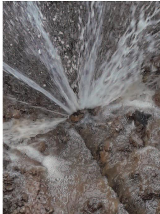
*Rohrbruch an einer alten Gussrohrleitung*
