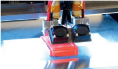
Ein erster Probedruck des Gehäuses für das Leitfähigkeitsmessgerät entsteht. (© Michael Thalken/Eifeler Presse Agentur/epa)
