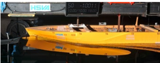
Abb. 6: Propulsionsversuch zur Untersuchung eines optimierten Eisklassepropellers.
