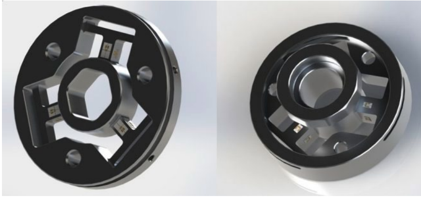
Abb. 16: Wellensensor (links), Blattsensor (rechts), CG-Modelle.
