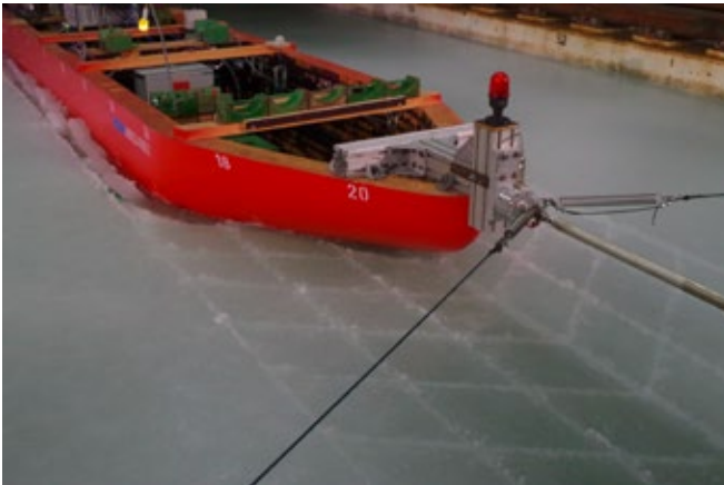
Abb. 5: Fahrt eines eisbrechenden Schiffmodells durch vorgesägtes Eis zur Validierung numerischer Tools.
