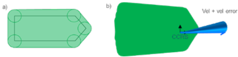
Abb. 3: a) sichere Schiffskontur unter Berücksichtigung des horizontalen Protection Levels und b) zusätzlicher Berücksichtigung des Heading-Fehlers
