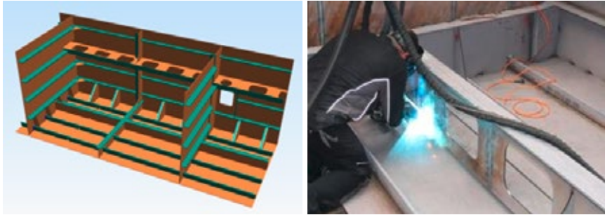
Abb. 15: a) CAD-Ansicht des Demonstrators (Quelle: Fr. Lürssen Werft); b) Schweißen des Demonstrators mit dem hybriden Handschweißsystem (Quelle: Fraunhofer IAPT)
