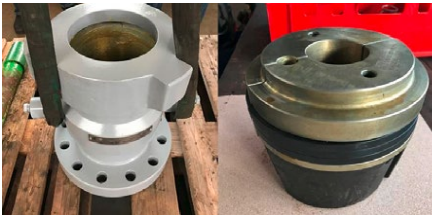
Abb. 9: Well Head mit Klemmvorrichtung, Dichtungen und Spannsystem
