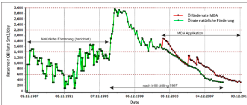
Abb. 20: Beispiel einer Ölproduktionsrate eines Ölfeldes und simulierte Prognose der natürlichen Förderung nach Infill Drilling und gegenüberstellt der Simulation des MDA-Einsatzes
