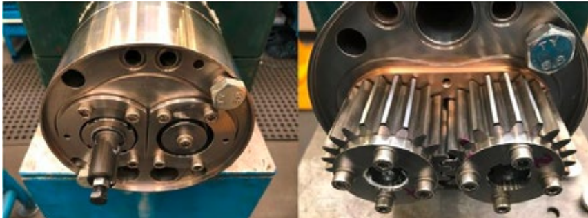
Abb. 2: Antriebs- und Getriebeseite des Pumpenmoduls
