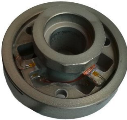
Abb. 17: Blattsensor mit applizierten DMS.
