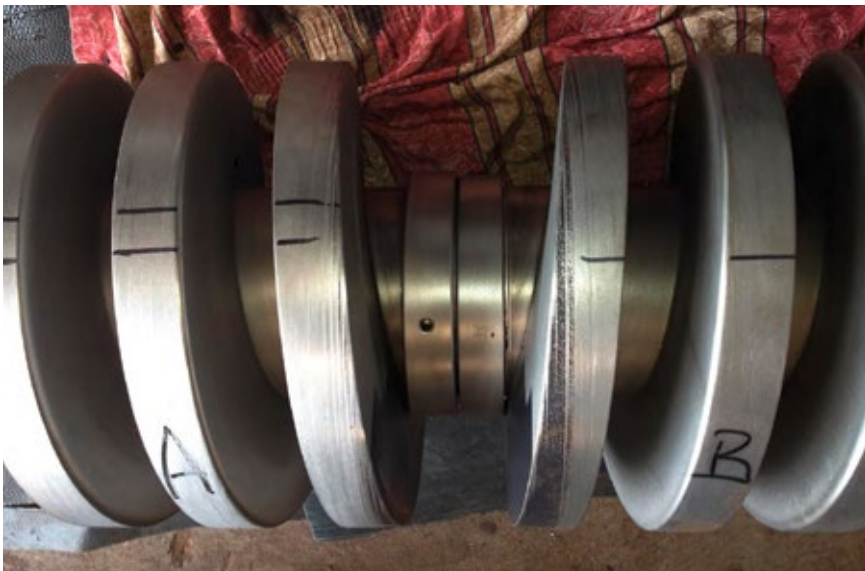
Abb. 6: Rotor mit kombinierten Korrosions- und Erosionsverschleiß
