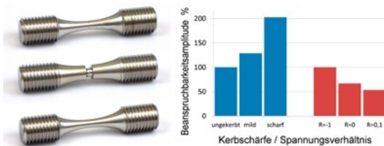
Abb. 25: EP aus Nickel-Basis in scharfer, milder und ungekerbter Ausführung (v.o.n.u.), sowie die relativen Beanspruchbarkeitsamplituden im Kerbgrund
