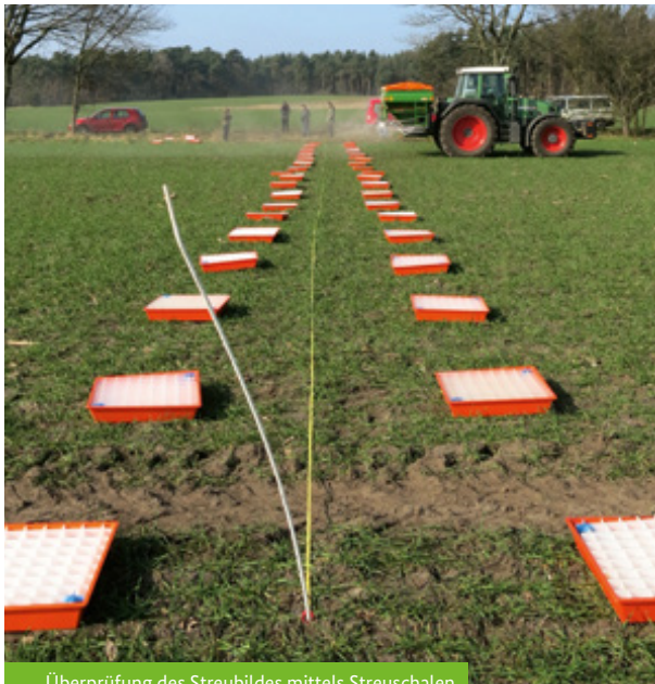
Überprüfung des Streubildes mittels Streuschalen
