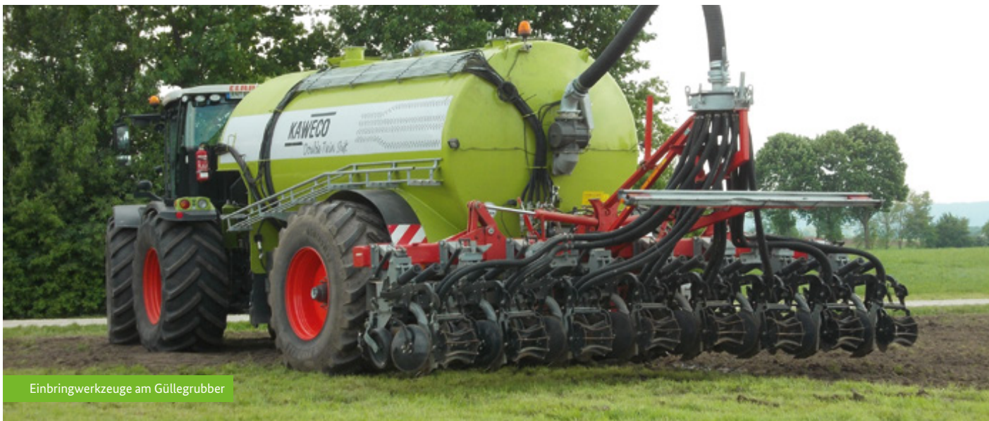
Güllegrubber zur unverzüglichen Einarbeitung im Einsatz
