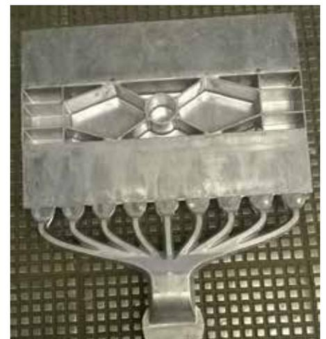
Verwendetes Prinzipbauteil zur Untersuchung von Strukturgusslegierungen und deren Fügeignung.
