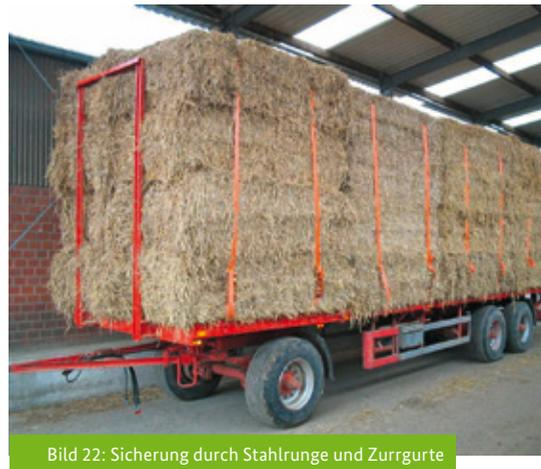
Bild 22: Sicherung durch Stahlrunge und Zurrgurte
