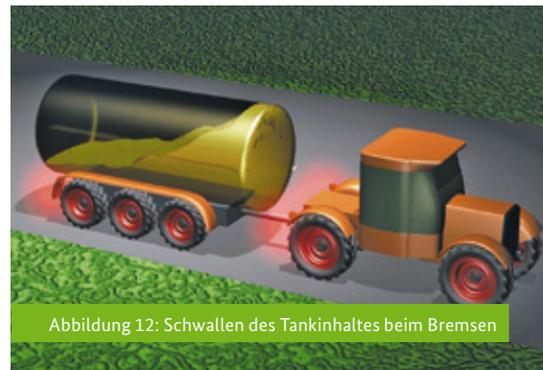
Abbildung 12: Schwallen des Tankinhaltes beim Bremsen
