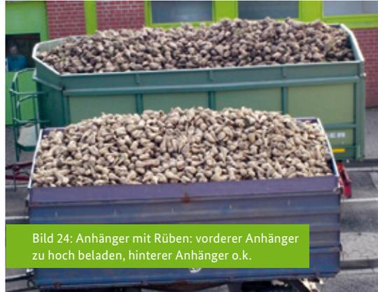
Bild 24: Anhänger mit Rüben: vorderer Anhänger zu hoch beladen, hinterer Anhänger o.k.
