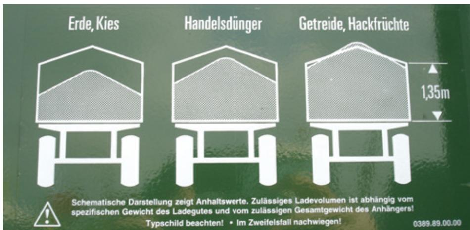
Bild 43: Ladungshöhen durch unterschiedliche Güter
