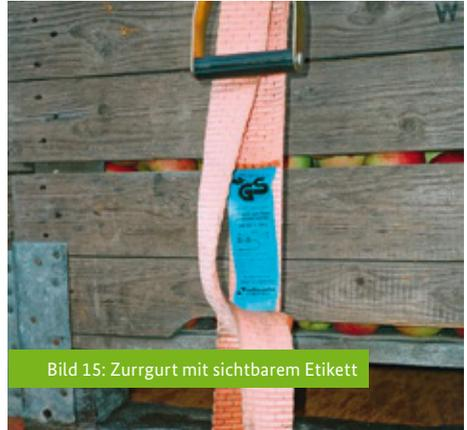
Bild 15: Zurrgurt mit sichtbarem Etikett
