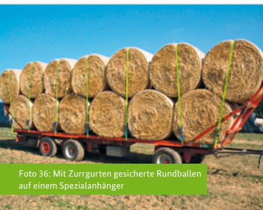
Foto 36: Mit Zurrgurten gesicherte Rundballen auf einem Spezialanhänger
