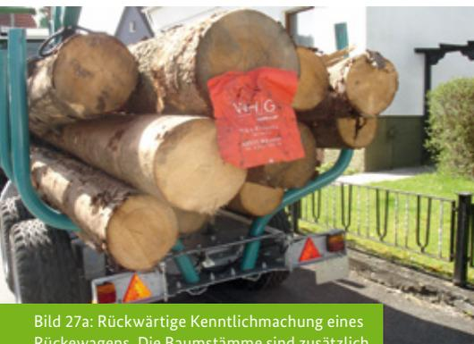
Bild 27a: Rückwärtige Kennlichmachung eines Rückewagens. Die Baumstämmen sind zusätzlich mit Zurrgurten gesichert.
