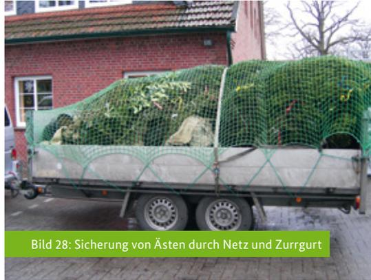
Bild 28: Sicherung von Ästen durch Netz und Zurrgurt
