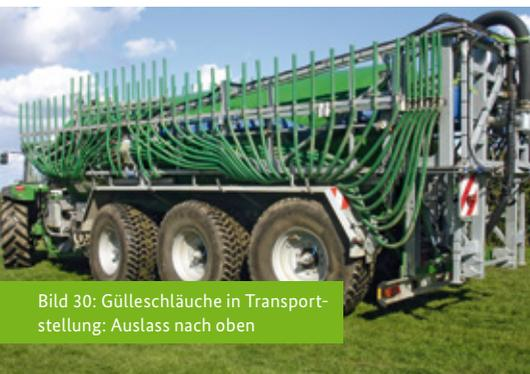
Bild 30: Gülleschläuche in Transportstellung: Auslass nach oben
