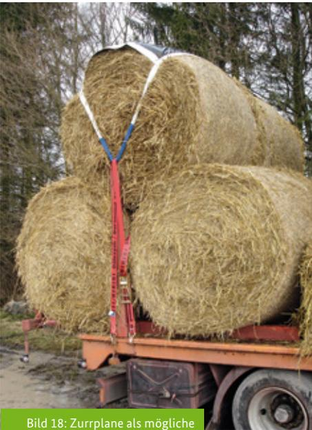
Bild 18: Zurrplane als mögliche Sicherung von Strohballen
