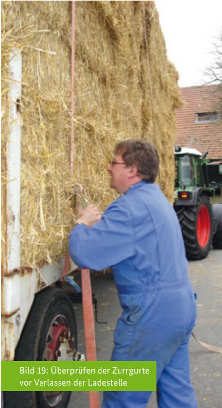
Bild 19: Überprüfen der Zurrgurte vor Verlassen der Ladestelle
