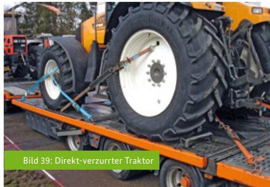
Bild 39: Direkt-verzurrter Traktor
