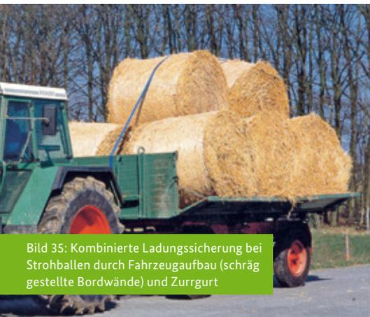
Bild 35: Kombinierte Ladungssicherung bei Strohballen durch Fahrzeugaufbau (schräg gestellte Bordwände) und Zurrgurte
