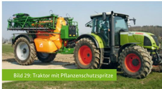
Bild 29: Traktor mit Pflanzenschutzspritze
