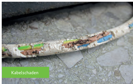
Rattenschaden an Stallgebäude
