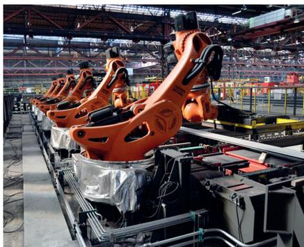
*Roboter walzen und bündeln die Stahlprofile bei der Firma Mannstaedt.*
