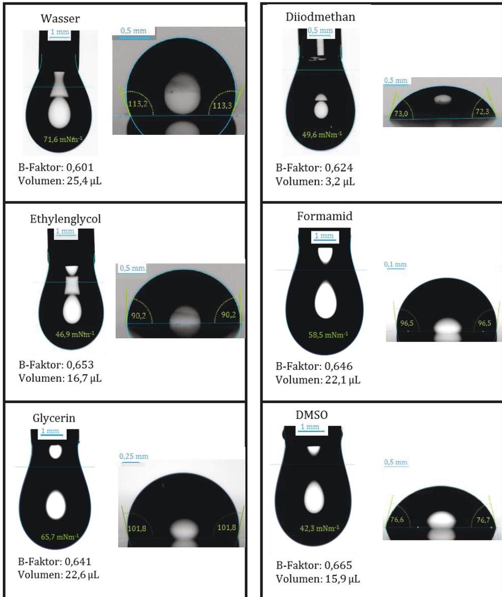
Abbildung 5.3: Tropfenformen der hängenden Tropfen mit den entsprechenden liegenden Tropfen auf PDMS von Wasser, Diiodmethan, Ethylenglycol, Formamid, Glycerin und DMSO (von links nach rechts und von oben nach unten.)
