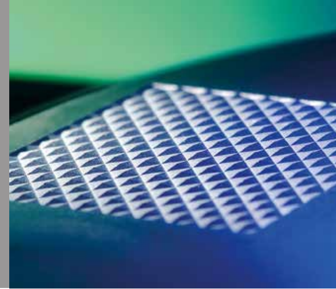
Funktionale Oberflächen: präzise und effizient hergestellt mit einem Kombiverfahren aus Nano- und Pikosekundenpulsen.
