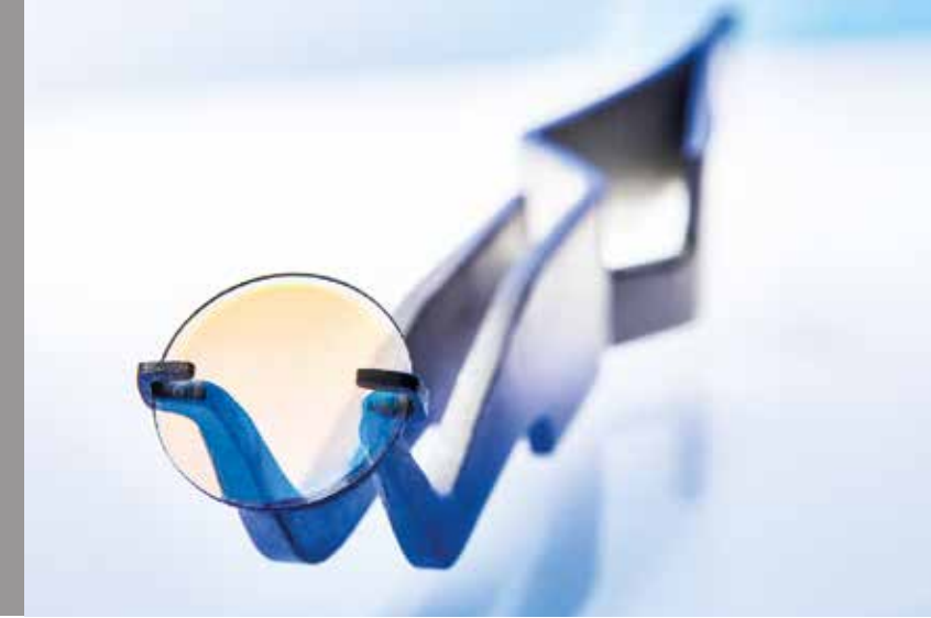
Ultrapräzisionsbearbeitung von Diamantlinsen für Laseroptiken.
