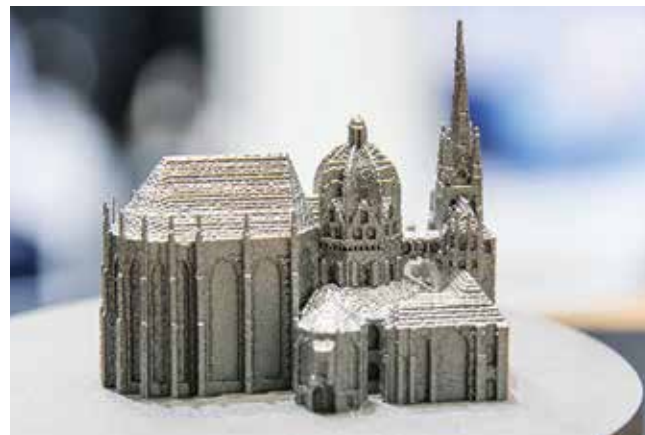
Miniaturausgabe des Aachener Doms, gefertigt mit der Low-Cost-SLM-Anlage des »GoetheLab for Additive Manufacturing« der FH Aachen in Kooperation mit dem Fraunhofer ILT.
