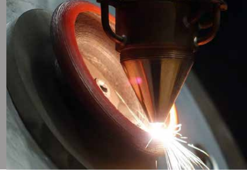
Roboterbasierte Additive Fertigung mit Laser Material Deposition.
