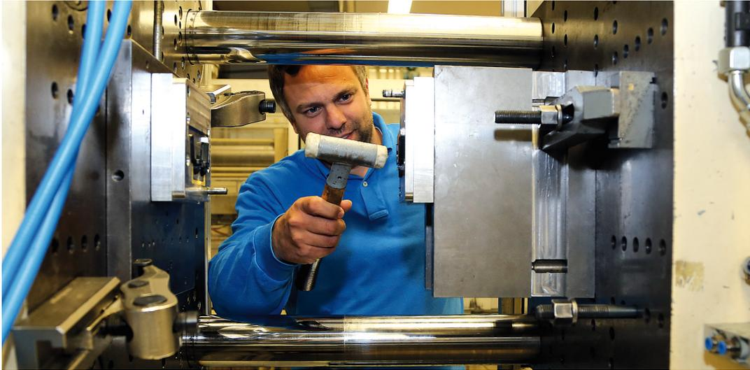
Sebastian Krell beim Einlegen der ersten, fertigen Komponente in die Spritzguss-Maschine zwecks Fertigung eines Mehrkomponenten-Bauteils. Foto: Stadt
