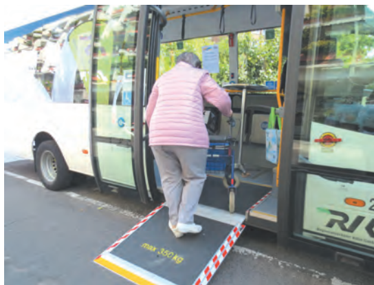
Buseinstieg mit Rampe
