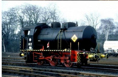
Die im Jahr 1952 von der Firma Krupp erbaute Dampfspeicherlok ging zuerst bei den Rheinischen Stahlwerken Abt. Arenberg-Bottrop für die Braunkohlegrube Schallmauer in Betrieb. Ihr nächster Einsatz war 1954 für die Braunkohlenbergbau & Brikettfabrikation, Köln 412.
