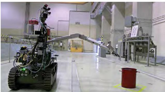
AKW Zwentendorf: Das UGV sichert radioaktives Material.
