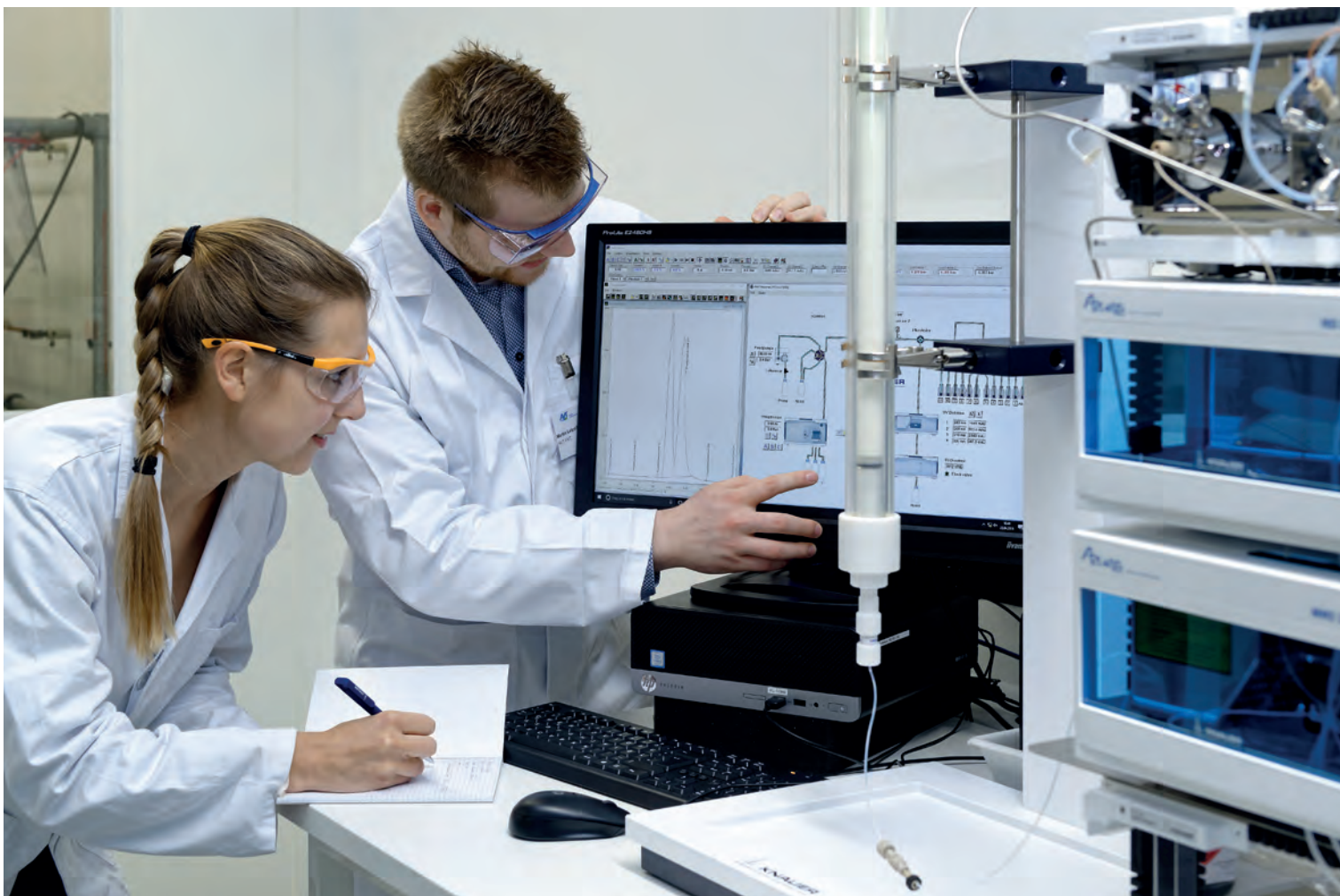
Bild 2: Mitarbeiterinnen und Mitarbeiter des Lehrstuhls für Fluidverfahrenstechnik entwickeln gemeinsam mit Studierenden das Design und die Fahrweise der Trennverfahren. Hier ein Versuchsaufbau einer präparativen Chromatografieanlage zur selektiven Abtrennung hochwertiger Komponenten aus komplexen Stoffgemischen. Foto: Peter Winandy
