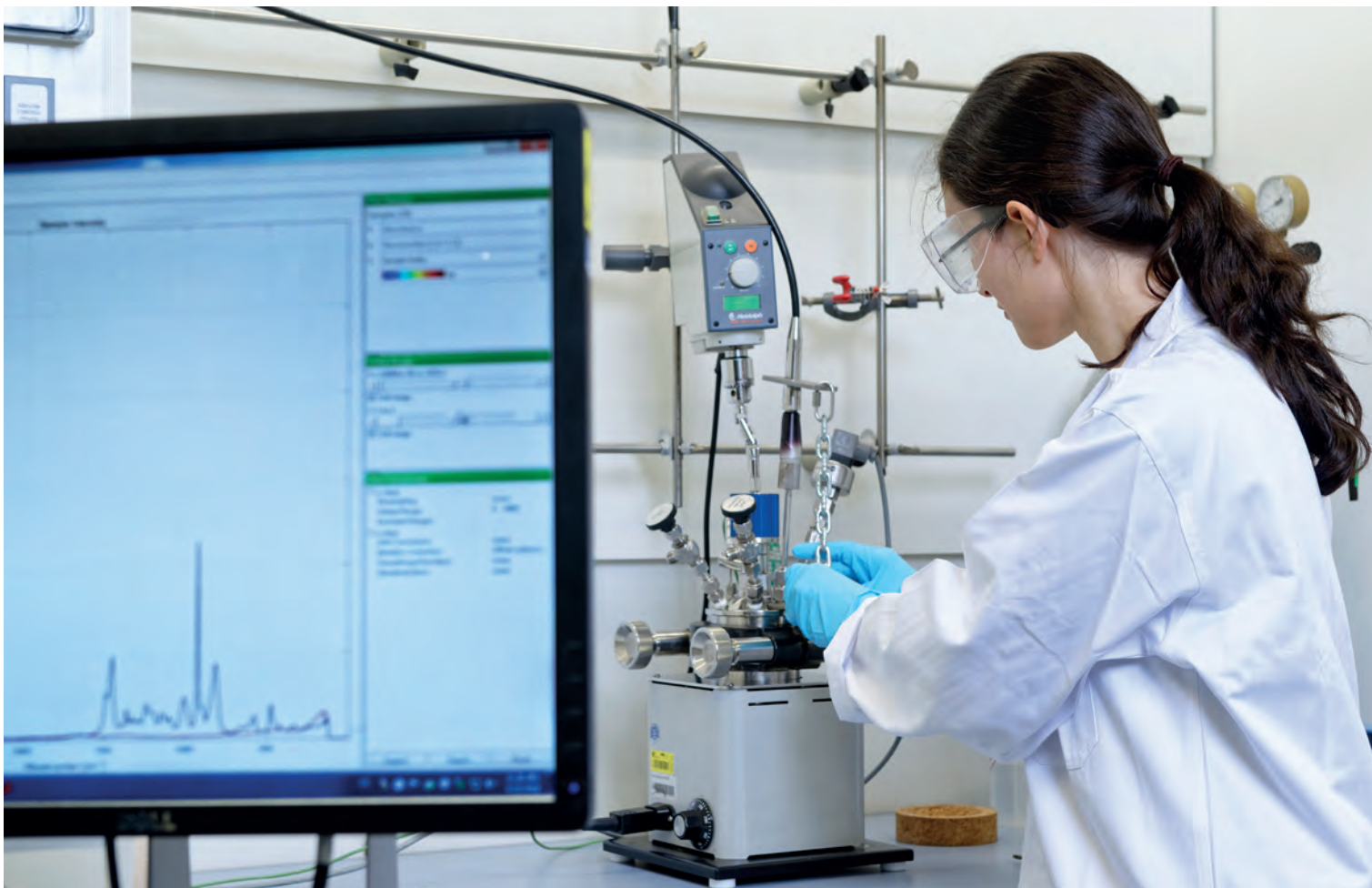
Bild 5: Am Lehrstuhl für Systemverfahrenstechnik wird eine Messung mit einer Spektroskopie-Sonde vorbereitet. Diese ermöglicht die Aufnahme von Konzentrationsverläufen der Stoffe während chemischer Reaktionen.
