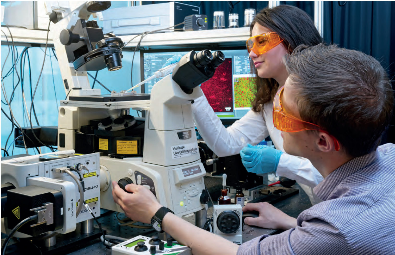
Bild 5: Vorbereitung einer Probe mit Mikrogelen zur Messung an einem multikonfokalen Spinning-Disk-Fluoreszenzmikroskop. Foto: Peter Winandy
