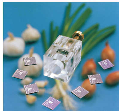
Abbildung 5: Sensormesszelle und einzelne Sensorchips.
