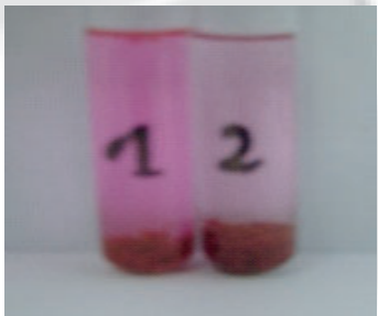
Abbildung 7: Farbstofffreisetzung durch Schrumpfung (1) der Partikel und Diffusion (2).
