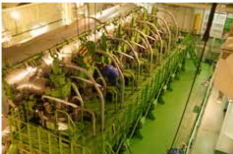
Die Hauptmaschine hat die Größe eines vierstöckigen Wohngebäudes und erzeugt eine Leistung von 34224 kW (46532 PS).
