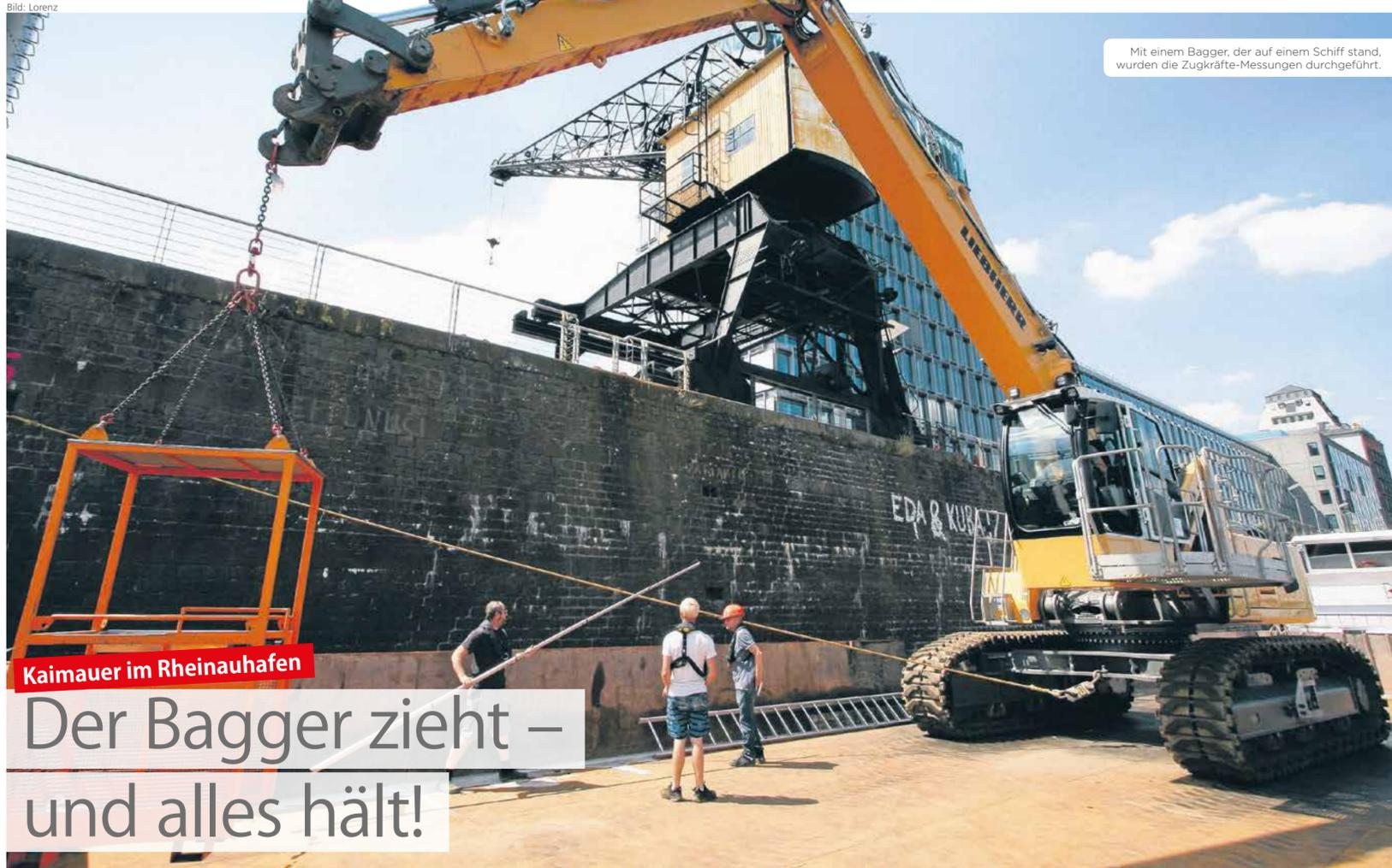
Mit einem Bagger, der auf einem Schiff stand, wurden die Zugkräfte-Messungen durchgeführt.
