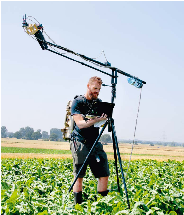
Ein Forscher nutzt das mobile Gerät FLOX, um die Chlorophyllfluoreszenz von Zuckerrüben zu vermessen.
