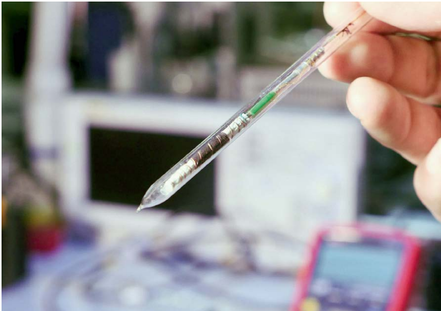
Jülicher und Münchner Wissenschaftler haben eine vorteilhafte Testzelle (l.) für die ESR-Spektroskopie (o.) entwickelt, mit der sich unter anderem „Alterungsprozesse“ in Akkus besser beobachten lassen.
