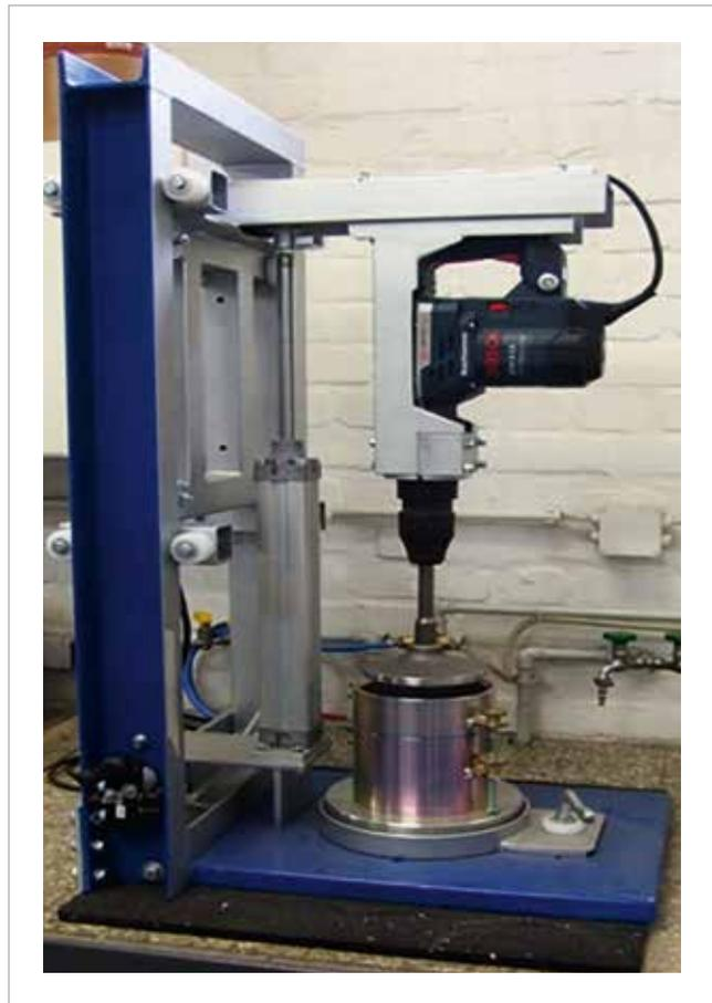
Abb. 1: Vibrationshammer, gebaut vom FEHS (Institut für Baustoffforschung e. V.)
