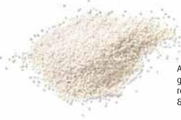
Abb. 1: Düngemittelpellets, gewonnen aus dem Wirbelbettreaktor von ALWIN EPPLER GmbH & Co. KG
