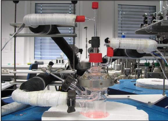
**Abb. 3.3** – Foto: CO<sub>2</sub>-Membranprüfstand zur Untersuchung des Permeationsverhaltens von OTMs.
