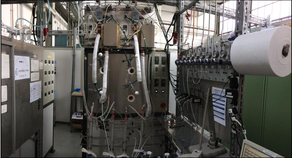
**Abb. 3.5.** – Foto: Wasserdampf-Membranprüfstand mit zugehörigem Befeuchtungs- und Kondensatauffangsystem am Vierrohr-Ofen.
