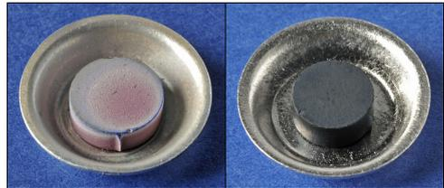
mit der Zusammensetzung  $\text{Ba}_{0,5}\text{Sr}_{0,5}\text{Co}_{0,8}\text{Fe}_{0,2}\text{O}_{3-\delta}$  durch die Auslagerung in Wasserdampf.  $\text{La}_{0,58}\text{Sr}_{0,4}\text{Co}_{0,2}\text{Fe}_{0,8}\text{O}_{3-\delta}$  scheint hingegen keine direkt sichtbaren Reaktionsprodukte auszubilden, obwohl es den selben feuchten Auslagerungsbedingungen ausgesetzt war.
