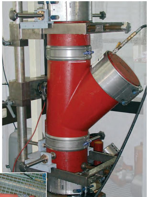
Wasserdichtheitsprüfung unter Innendruck bei Abwinkelung und Scherlast als überlagerte Beanspruchungen
