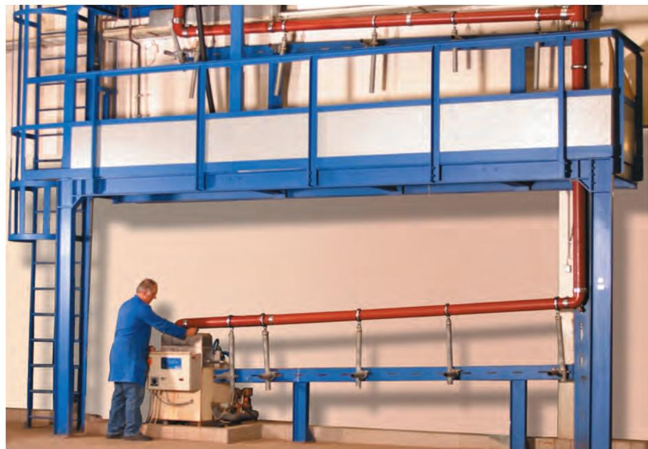
Versuchsaufbau zur Ermittlung der Temperaturwechselbeständigkeit (MPA-Dortmund)
