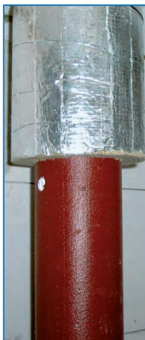
**Nach dem Abkühlen des Ofens wurden die Deckenplatten demontiert. Rohre und Isolierungen haben dem Feuer über 90 Minuten standgehalten.**
