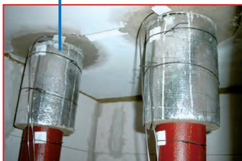
Die zu untersuchenden gusseisernen Abwasserrohre DN 100 der Unternehmen SAINT-GOBAIN HES (PAM-GLOBAL® S) und Düker (SML) wurden sowohl durch die Decke über dem Beobachtungsräume im Untergeschoss als auch durch die Decke über dem Brandraum hindurchgeführt.
