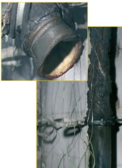
Beobachtungsraum Untergeschoss: Kunststoffrohre nach Brandversuch
