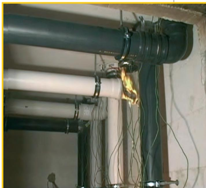
Durch herabfallenden brennenden Kunststoff wird der Brand vom Brandraum Erdgeschoss in den Beobachtungsraum Kellergeschoss übertragen.
