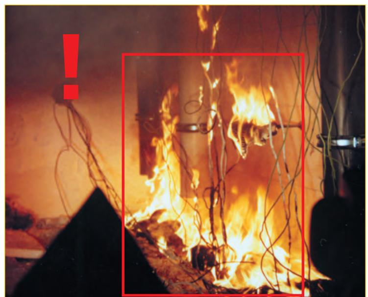
Beobachtungsraum Untergeschoss: Brennende Kunststoffrohre – kurz vor Abbruch des Brandversuchs
