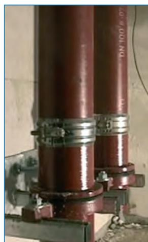
Beobachtungsraum Untergeschoss: unbeschädigte Gussrohre nach Brandversuch
