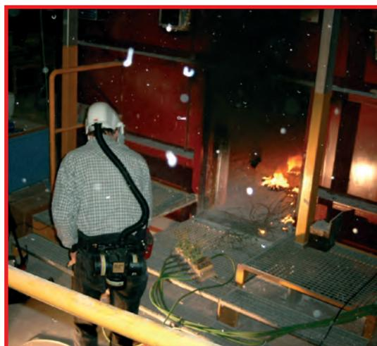
Löscharbeiten nach vorzeitigem Abbruch des Brandversuchs
