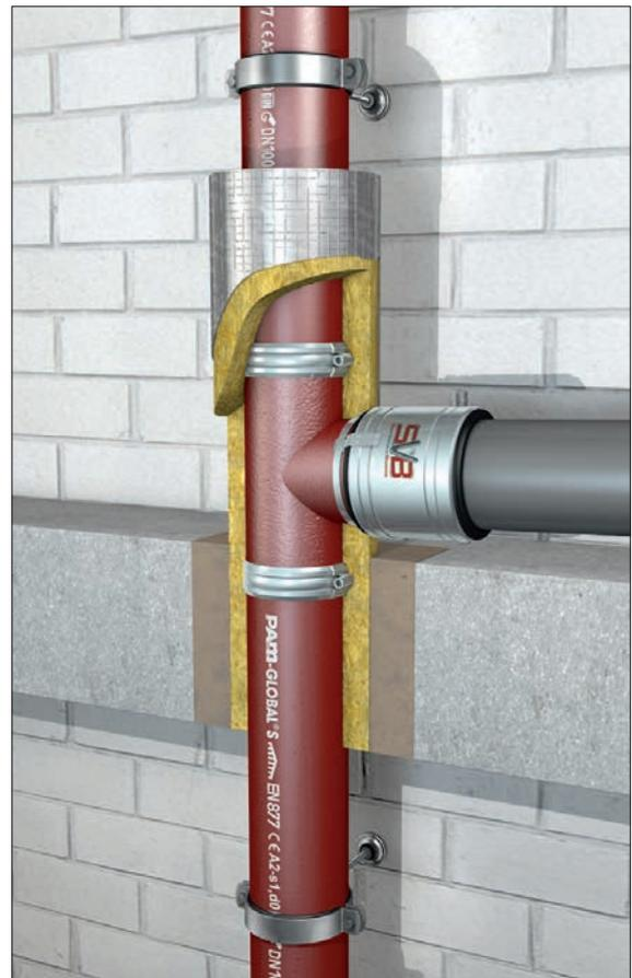
Bild 9: Einbau der Steck-Verbindung-Brandschutz SVB mit abZ-Nr. Z-19.17-2130 in die waagerechte Anschlussleitung (SAINT-GOBAIN HES)
