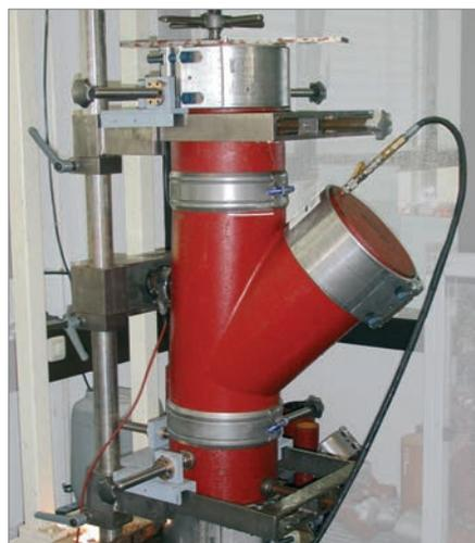
Bild „Wasserdichtheitsprüfung unter Innendruck bei Abwinkelung und Scherlast“
