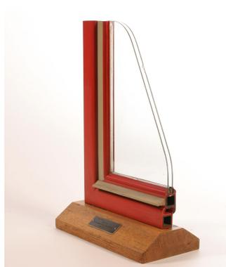
Schnittmodell (Fenstercke eines der ersten Kunststoff-Fenster der Welt Mipolam Elastic (Foto: Rainer Hardtke)
