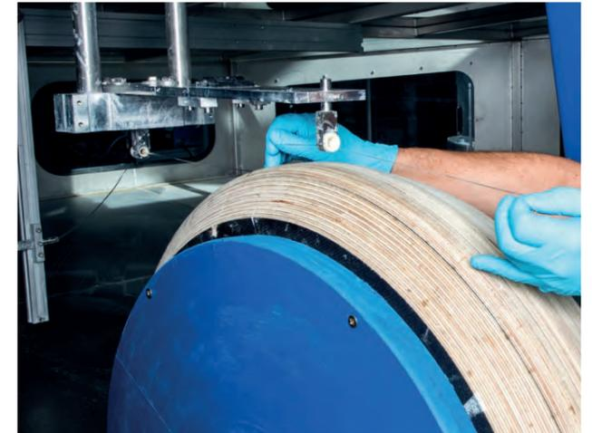
Anlage zum Wickeln faserverstärkter Oxidkeramik im DLR Köln
