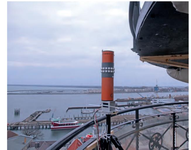
Während einer Messkampagne im Jahr 2014, bei der die Wissenschaftler die Funkverbindung zwischen einem Schiff und dem Festland untersuchten, wurde die Empfangsantenne auf dem Leuchtturm von Warnemünde installiert. 2016 erfasste ein Team den Übertragungskanal zwischen zwei Schiffen (das DLR-Magazin 149 berichtete in einer Reportage darüber).
