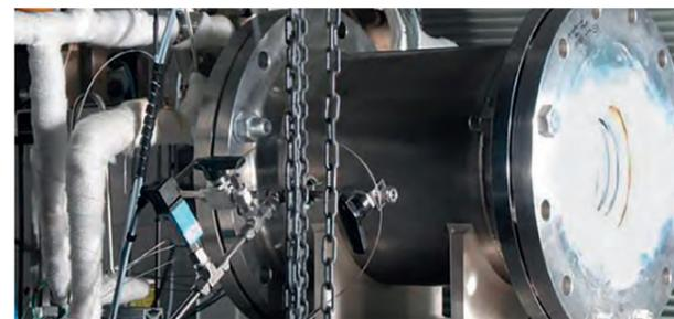
Der Versuchsaufbau kombiniert eine Hochtemperatur-Elektrolyse mit einem speziellen Solarwärmeabsorber und Dampferzeuger. Im Bild von rechts kommt die Strahlung der künstlichen Sonne.
