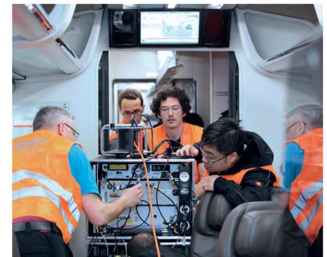
In zwei fahrenden Hochgeschwindigkeitszügen untersuchten die DLR-Experten in Italien die Ausbreitung der Funkwellen für die Kommunikation von Zug zu Zug
