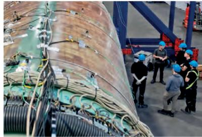
Rotorblatt mit Sensoren zum Messen des Schwingungsverhaltens
