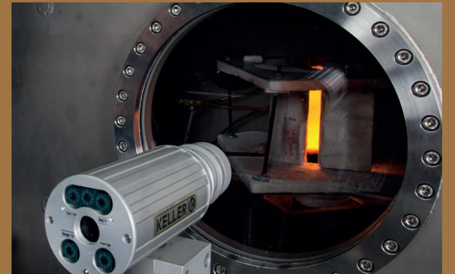
Blick ins Innere der Anlage Indutherm: Bei sehr hohen Temperaturen weit über 1.000 Grad Celsius kann die Probe hier mechanisch geprüft werden.
