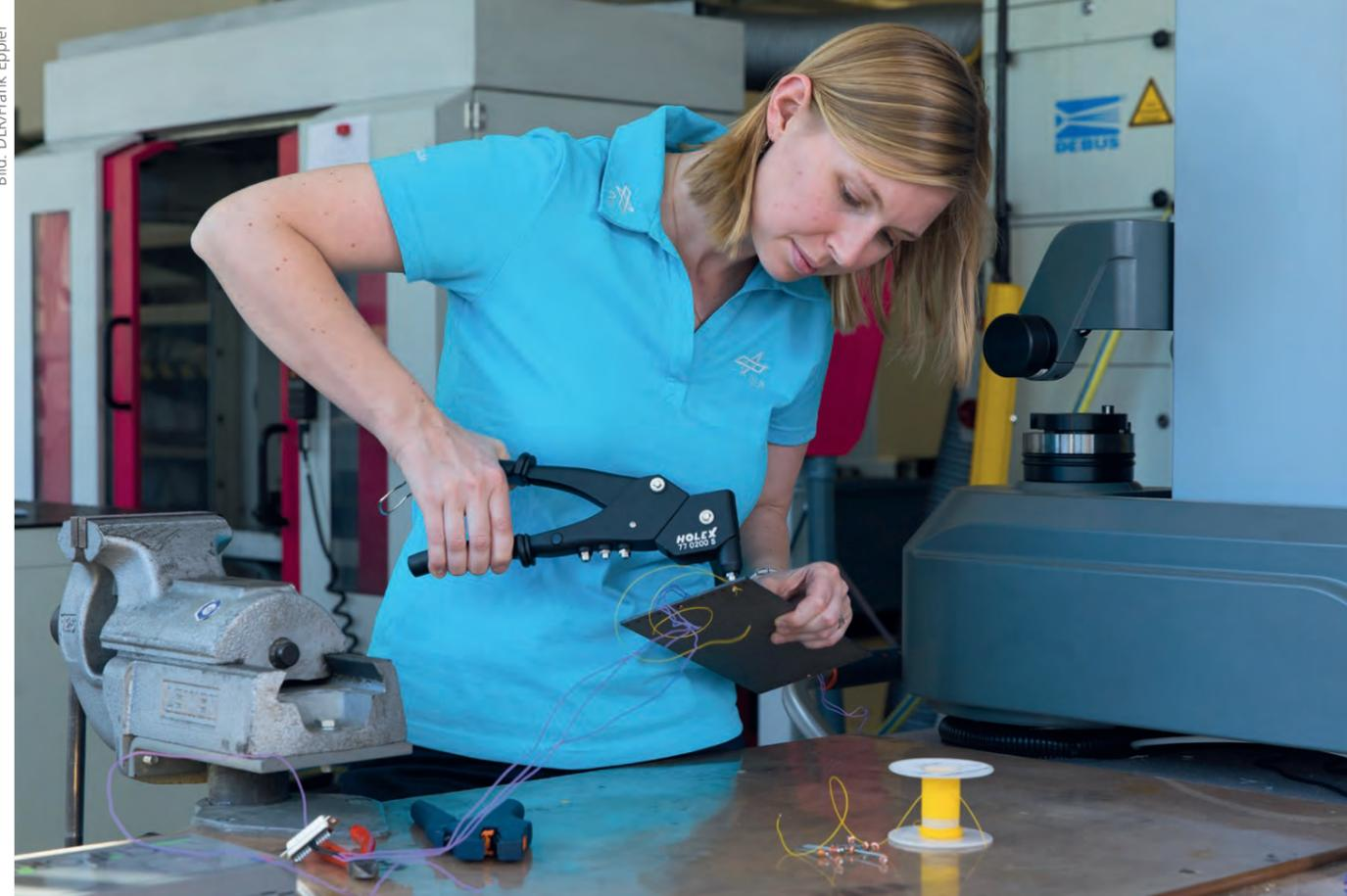
Tina Stähler in der Werkstatt des Instituts für Bauweisen und Strukturtechnologie in Stuttgart: Das Anbringen von Kontakten auf der Probenplatte erfolgt nach einem genau überlegten System. Das Netz der Messpfade soll möglichst feinmaschig sein.
