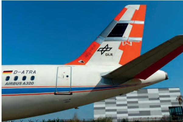
Das innovative Absaugsystem befindet sich am Seitenleitwerk des DLR-Forschungsflugzeugs ATRA
