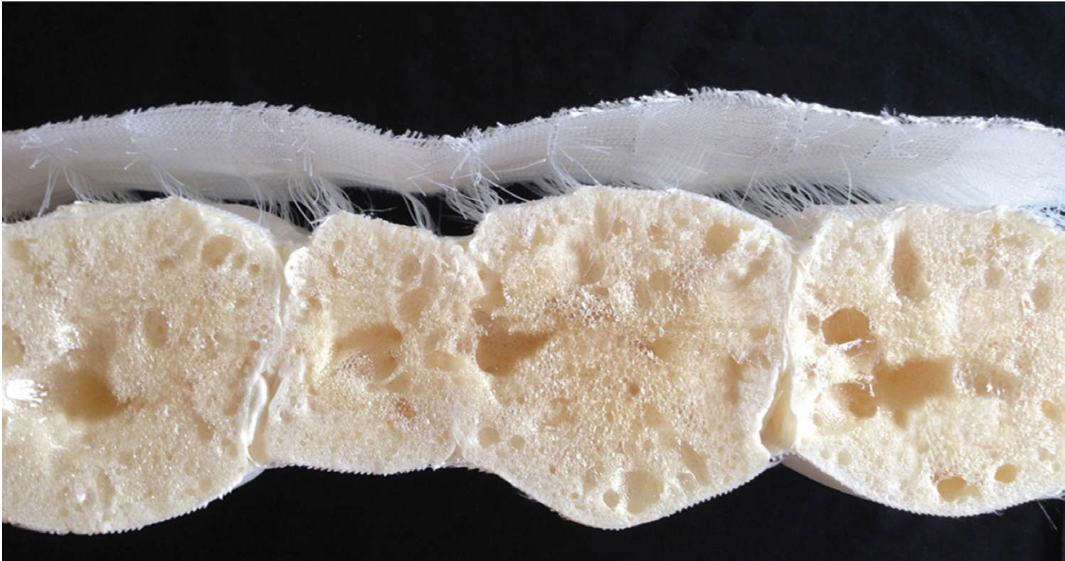
Abbildung 46: 3dTEX – Geschäumtes Abstandsgewebe
