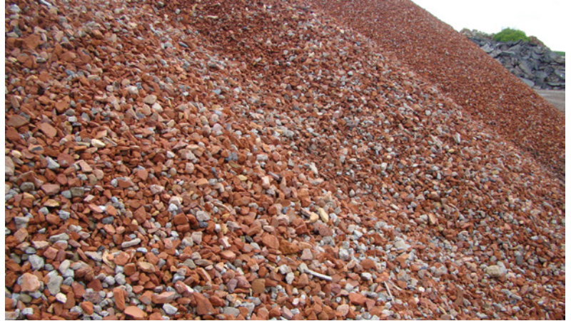
Abbildung 99: Recycling-Baustoffe aus Mauerwerkbruch
