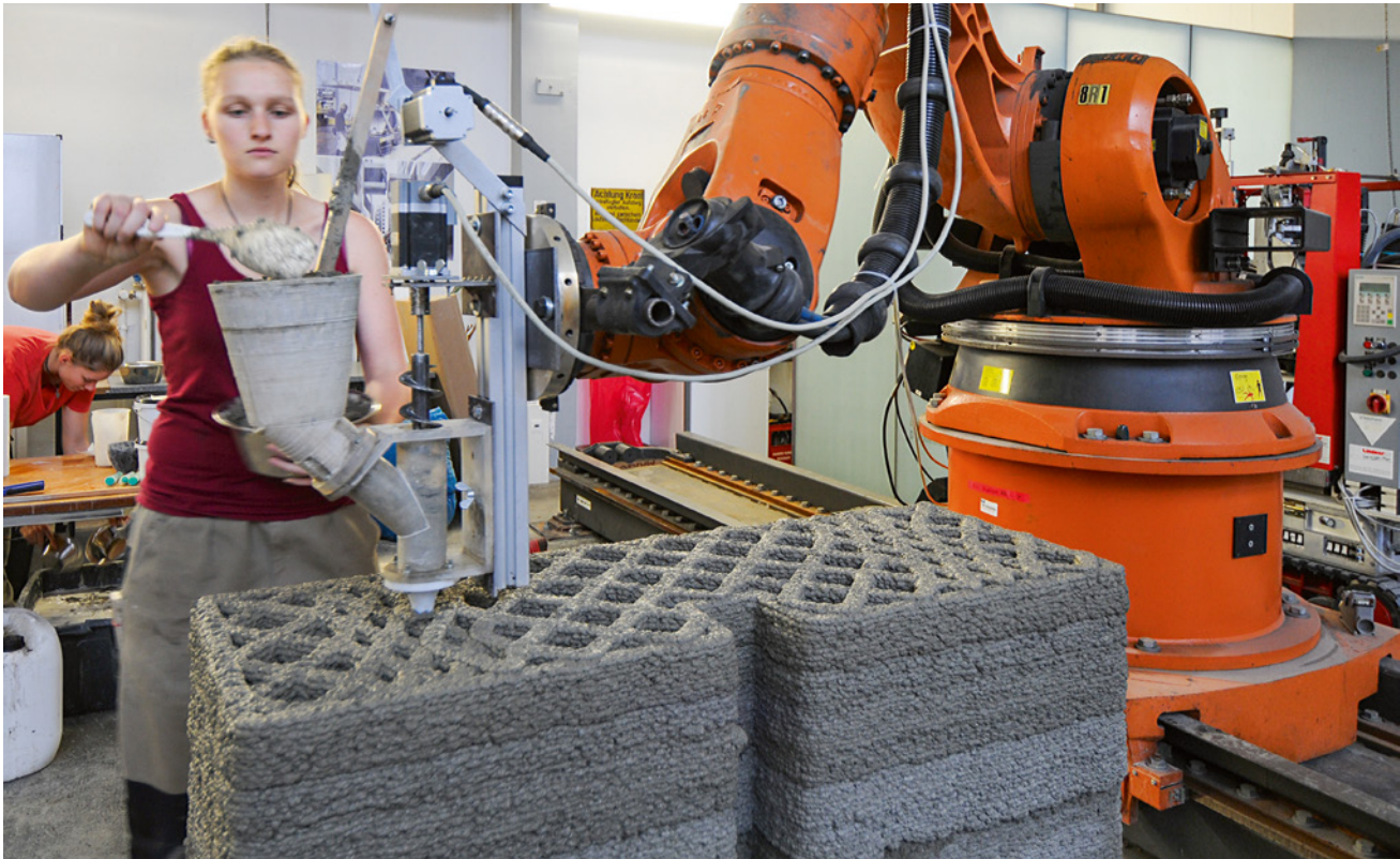
Abbildung 112: Herstellung eines multifunktionalen Wandelements durch Extrusion von Holzleichtbeton. Auf dem Bild erkennbar sind Zonen unterschiedlicher Dichte und ein integrierter Installations-schacht.
