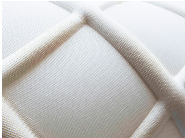
Abbildung 47: 3dTEX – Leichtwandelement aus geschäumtem einlagigen Abstandsgewirke
