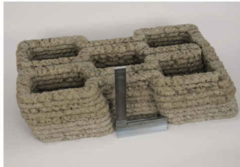
Abbildung 114: Durch Extrusion von Holzleichtbeton gefertigtes Testobjekt mit Überhang von 26 %
