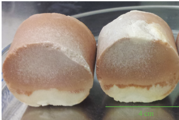
Abbildung 4.10: Fotografie von zwei 20Al-LLZO-Pellets die während der Kalzinierschritte direkten Kontakt zum \text{Al}_2\text{O}_3 Tiegelboden hatten. Die Bildung einer Li- und Al-reichen Phase wird durch ICP-OES bestätigt. Stoffmengenverhältnis wurde auf 3 mol La normiert; helle Phase: Ist = \text{Li}_{9,6} : \text{Al}_{1,3} : \text{La}_3 : \text{Zr}_{1,85} (Soll = \text{Li}_{6,4} : \text{Al}_{0,2} : \text{La}_3 : \text{Zr}_2 ).
