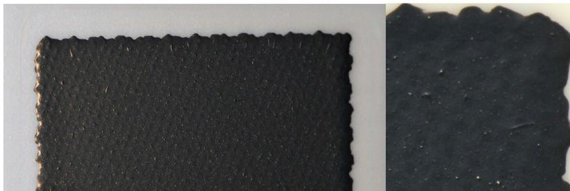
**Abb. 4.24:** Fotos der bei  $850\ \text{°C}$  für 3 h an Luft gesinterten Siebdruckschicht der Paste *LSCF* ( $0,3\ \mu\text{m}$ ) #4 aus nanostrukturiertem LSCF Pulver ( $d_{50} \approx 0,3\ \mu\text{m}$ ) auf YSZ Substrat.
