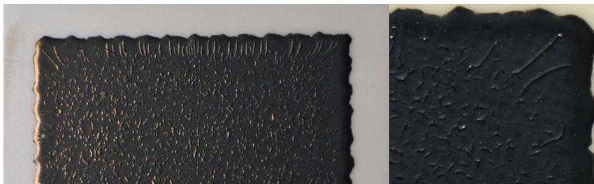
**Abb. 4.23:** Fotos der bei  $850\ \text{°C}$  für 3 h an Luft gesinterten Siebdruckschicht der Paste *LSCF* ( $0,3\ \mu\text{m}$ ) #3 aus nanostrukturiertem LSCF Pulver ( $d_{50} \approx 0,3\ \mu\text{m}$ ) auf YSZ Substrat.
