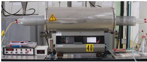
Abbildung 3-7: Grundlegender Aufbau des Vergiftungsmesstandes zur Gasphasenabscheidung von Chrom.
