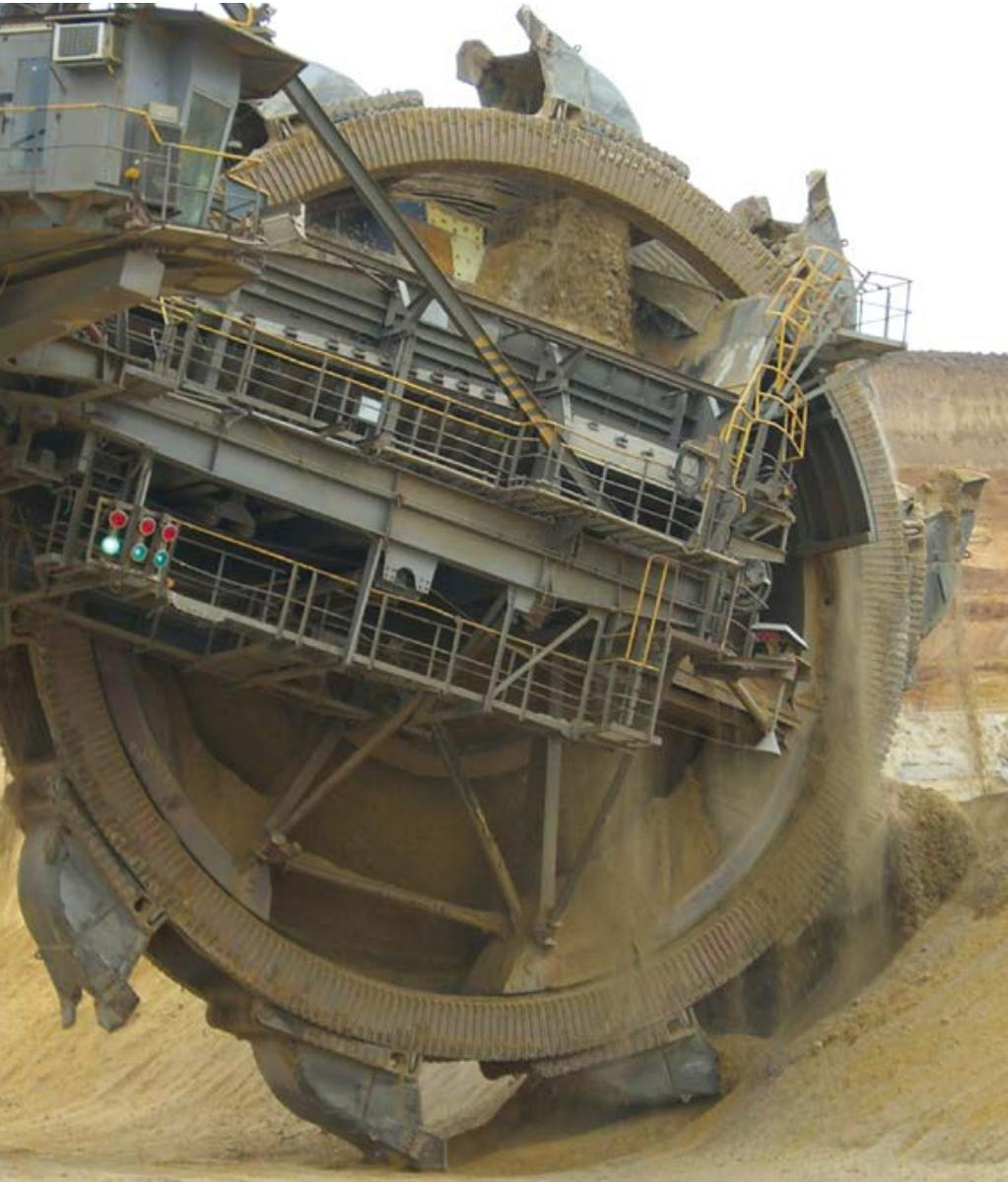
Schaufelradbagger im Tagebau Hambach
