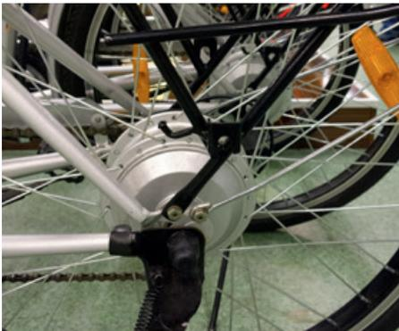
Der **Heckantrieb** befindet sich in der Nabe des Hinterrades. Er bietet insbesondere Traktionsvorteile am Berg.
