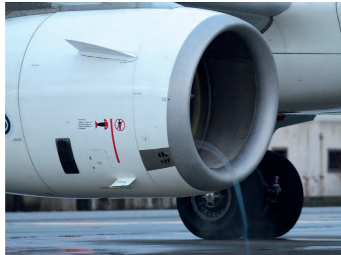
Im Standlauf: Während der Bodenmessungen sieht man in hellem Blau-Grau einen Abluftwirbel, der aus dem Triebwerk des A320 ATRA „herausfällt“.
