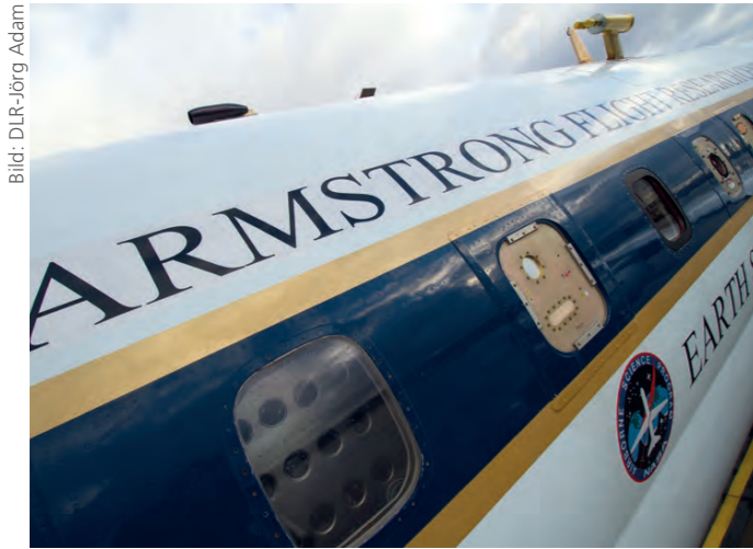
An der Seite des „Fliegenden Labors“ DC-8: Lufteinlässe und Messinstrumente
