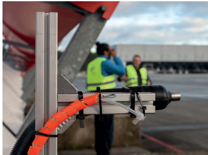
Über einen Lufterlass und ein Schlauchsystem werden die Abgase zu den Messinstrumenten geleitet
