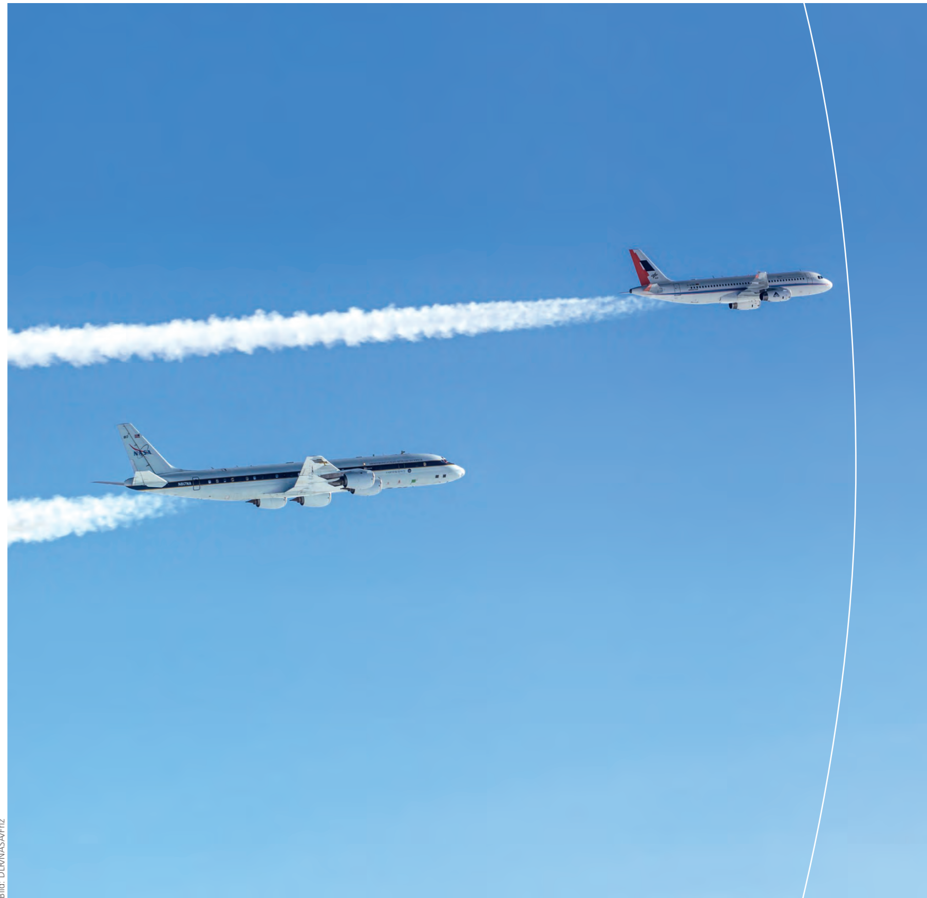
Auf dem Weg in den Abgasstrahl: die DC-8 der NASA (links) hinter dem A320 ATRA des DLR
