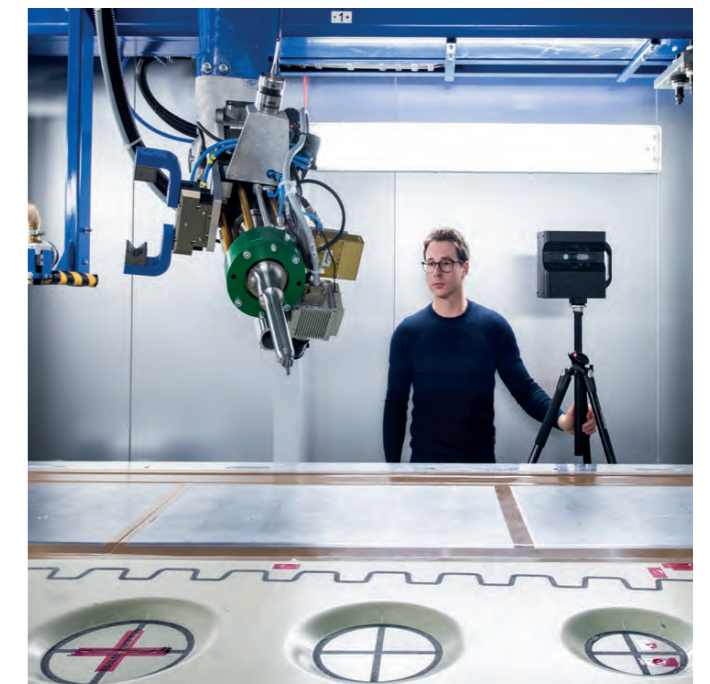
Geburtsstunde eines digitalen Zwillings. Die Kamera scannt jeden Winkel und jede Ecke der Anlage ein.
