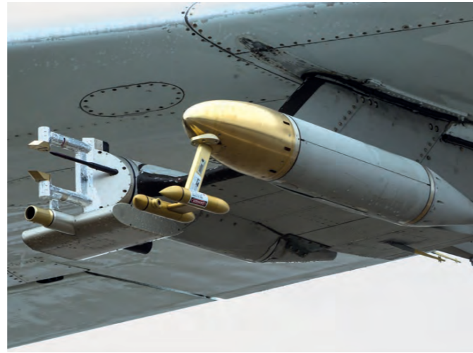
Sonden zur Messung der Größe, Anzahl und Form von Eiskristallen in Kondensstreifen
