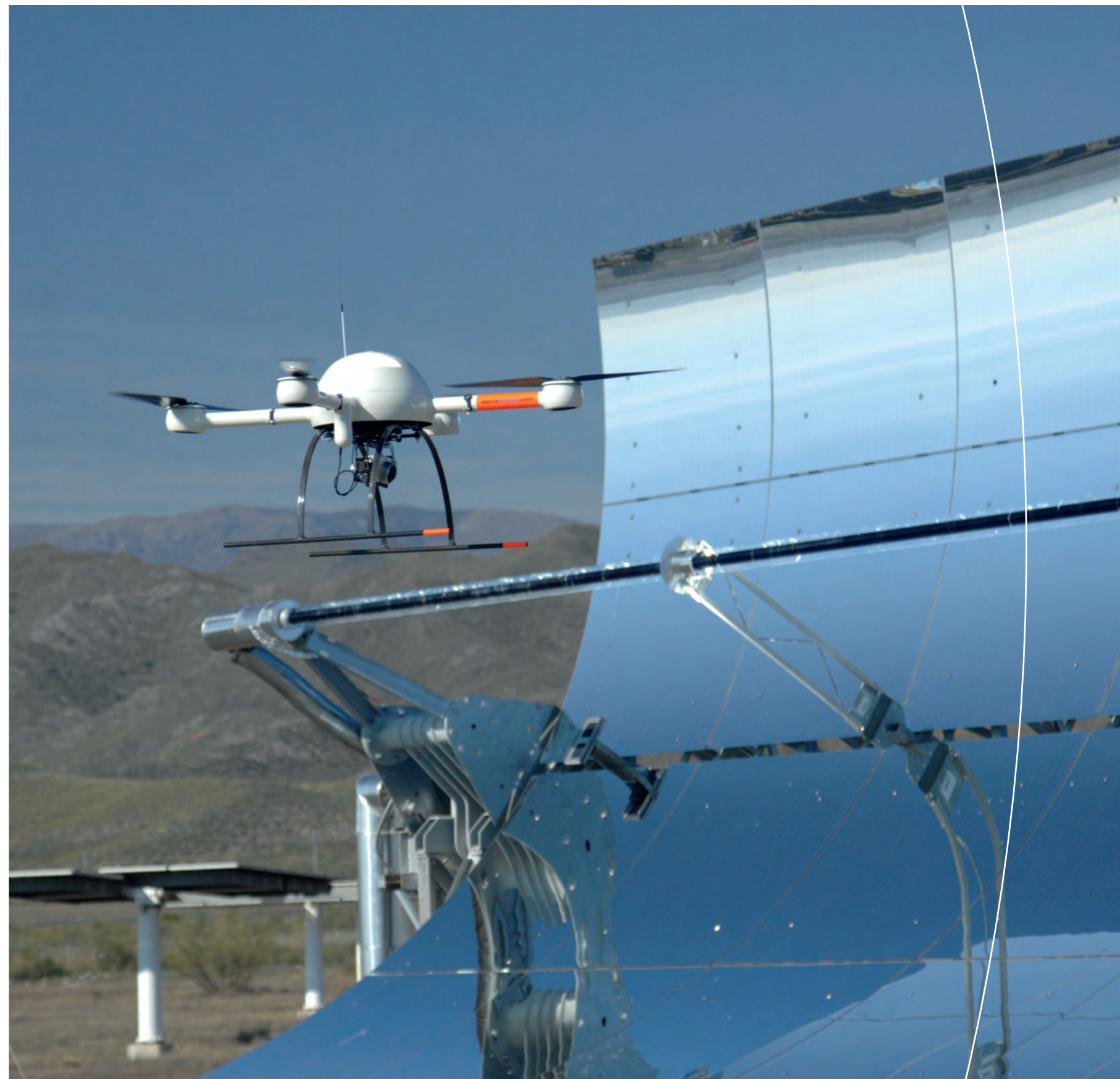
Schnelle Erfassung aus der Luft: Mit Hilfe des fliegenden Kamerasystems QFly werden die Parabolspiegel eines Solarkraftwerks vermessen. Mit den Daten kann der Betrieb optimiert und der Ertrag gesteigert werden.
