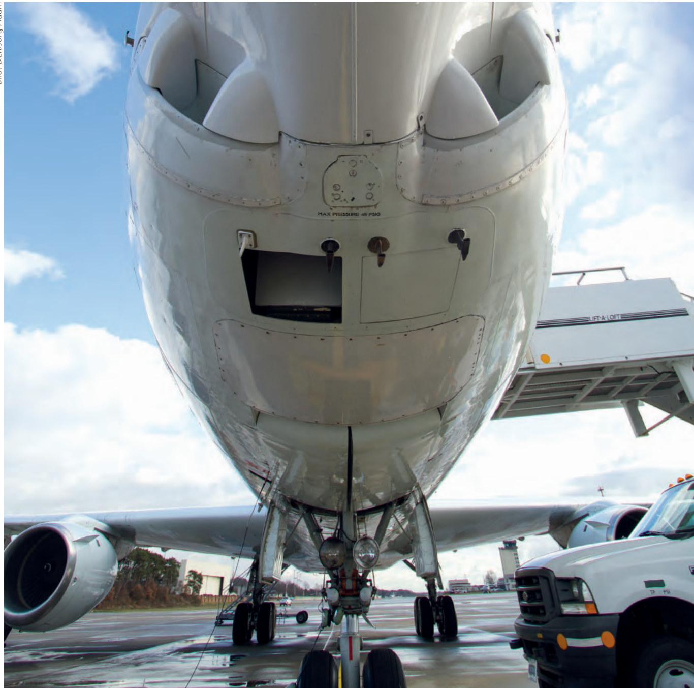
Im Rumpf der DC-8 der NASA zu erkennen: Lufteinlässe für die Abgasmessungen
