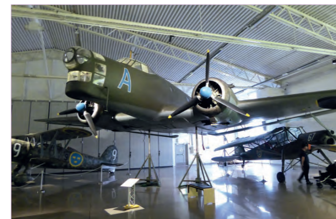
Mit diesem Mittelstreckenbomber verließ Junkers die traditionelle Wellblech-Bauweise zugunsten einer aerodynamisch besseren Glatthaut-Beplankung. Der ausgestellte Typ ist die weltweit einzig noch erhaltene Junkers Ju 86.
