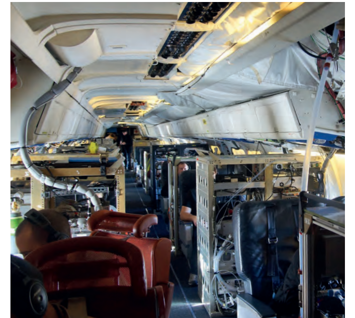
In der Kabine der DC-8: Gut zu sehen sind die Schläuche, in denen die Außenluft in die zahlreichen Instrumenten-Racks geführt wird. Rund die Hälfte der Instrumente an Bord stammt vom DLR.
