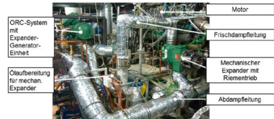
Abbildung 12: Versuchsaufbau ORC-Funktionsmuster mit mechanischer Einkopplung
