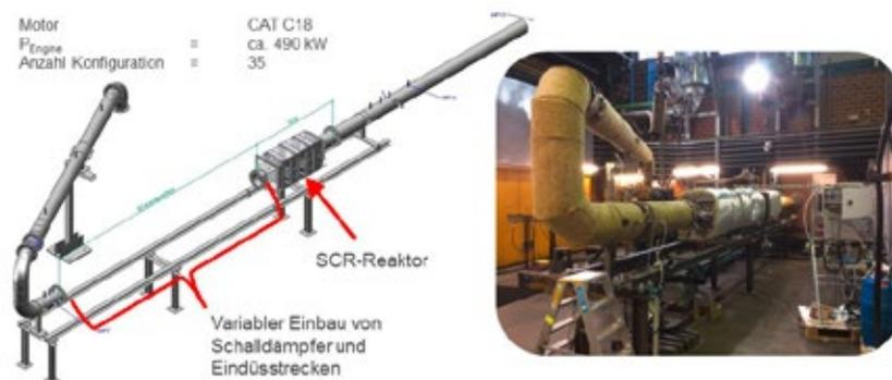
Abbildung 11: Prüfstand bei Zeppelin in Achim
