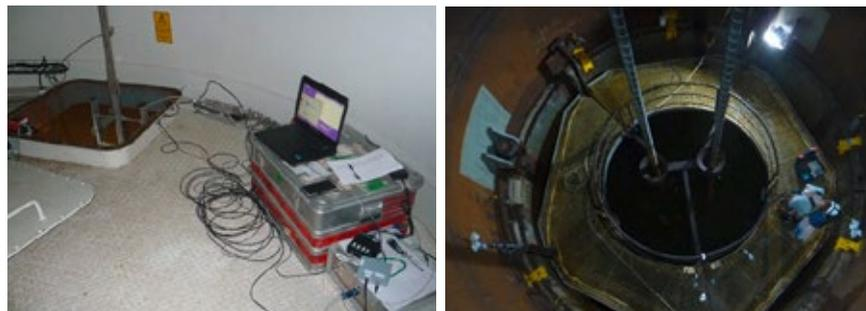
Abbildung 5: Messplatz oberhalb der Grout-Fuge (links) und Blick durch die Luke zur Grout-Fuge mit instrumentiertem Aktor und Sensor (rechts)
