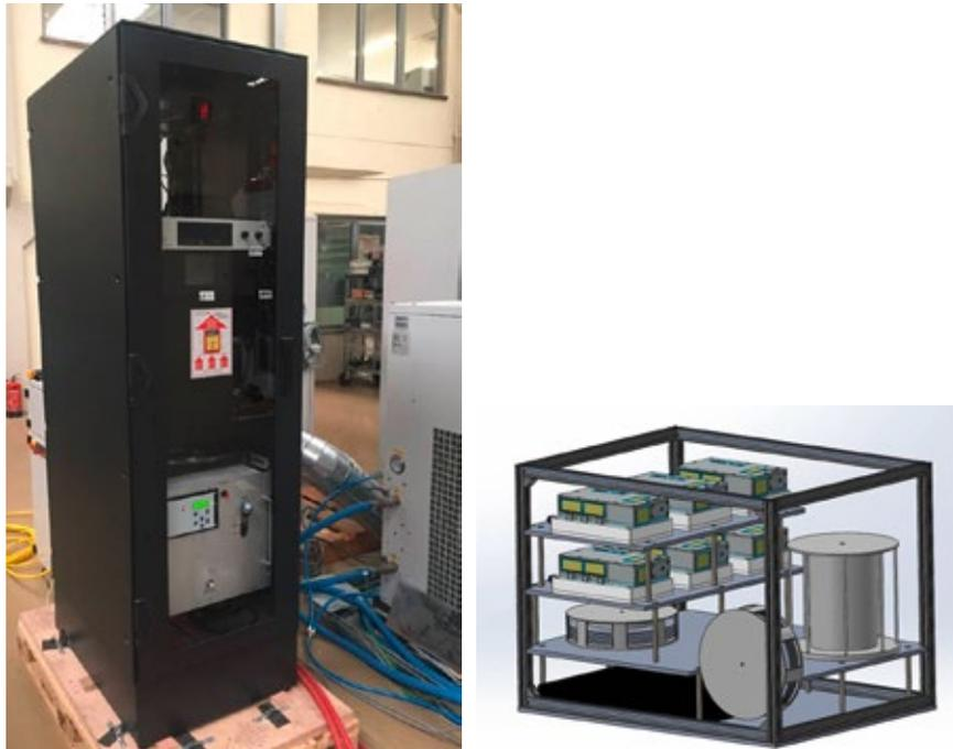
Abb. 3: Links: Vollständiges Lasersystem bestehend aus Faserlasereinheit, Elektronikeinheit sowie Kühlheit. Rechts: Design der Faserlasereinheit.
