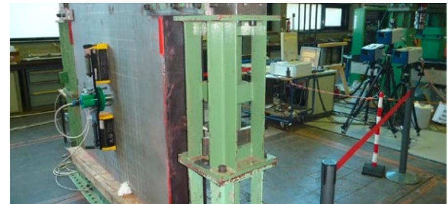
Abbildung 7: Aktor, rechts: Laservibrometer als sensorisches Element
