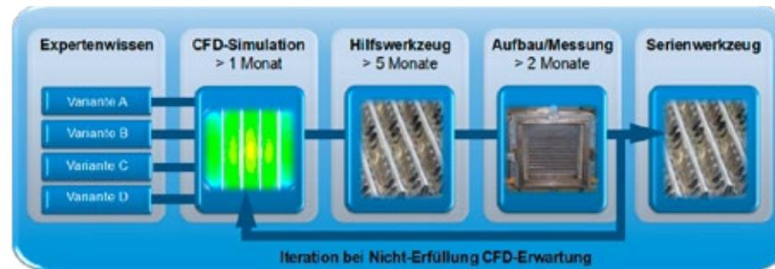
Abbildung 2: Ablauf Wellrippenentwicklung nach Stand der Technik
