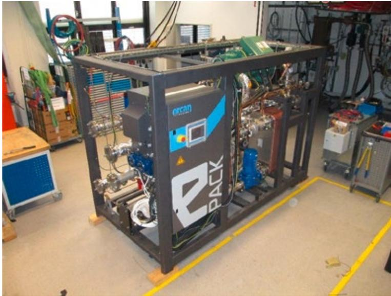
Abbildung 11: ORC-System (Funktionsmuster) nach Montage
