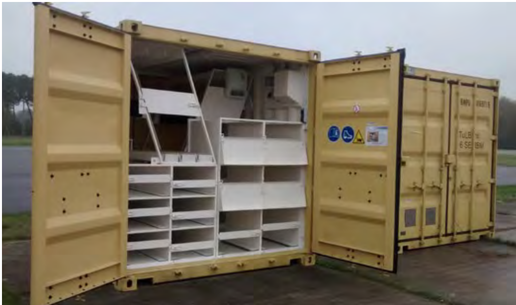
Transport- und Lagerbehälter mit Einbausatz
