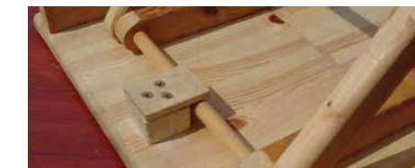
Final den Klotz anschrauben.
