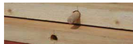
Der Dübel wird in die Tischplatte eingeleimt.
