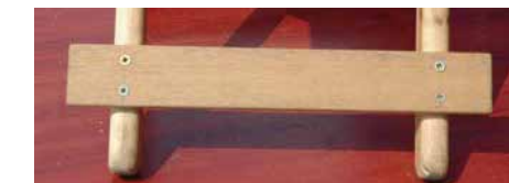
Die Querleisten sorgen für Stabilität.
