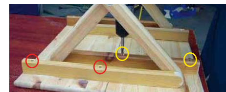
Achtung! Leisten nur mit Hälfte der Platte verschrauben.
