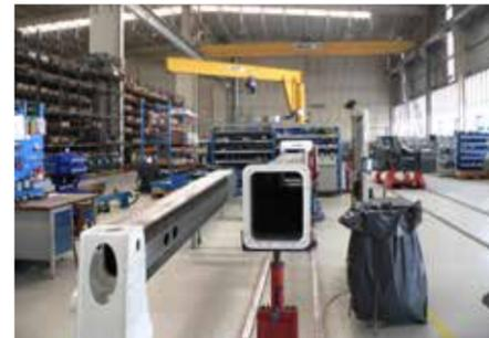
Hier wird auf der Montagelinie gerade ein Ausleger für den Teleskoplader zusammengesetzt.
