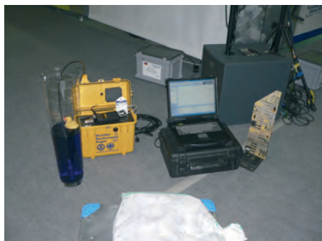
Mobiler HW-Pegel im Detail.
