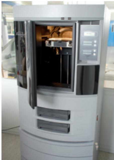
Mit diesem Heißfaden-Drucker werden dreidimensionale Produktmodelle hergestellt.
