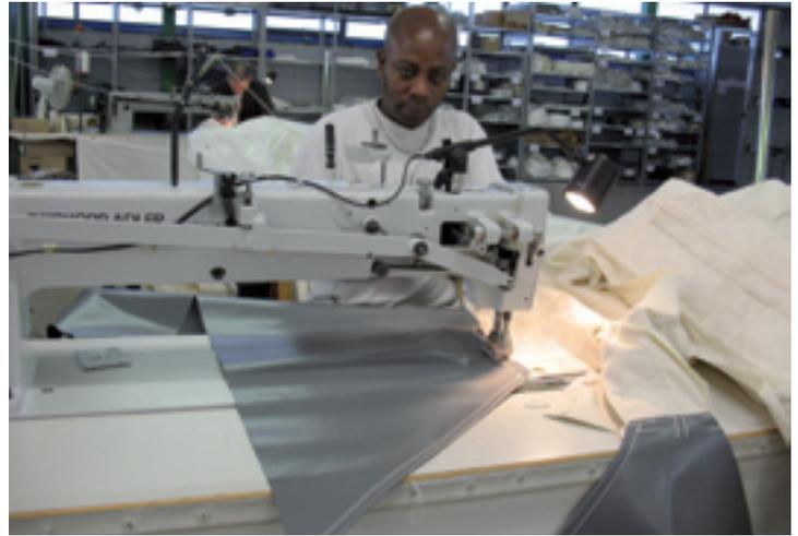
An dieser Stelle der Produktion wird der Faulstreifen an die Zeltwand angenäht.
