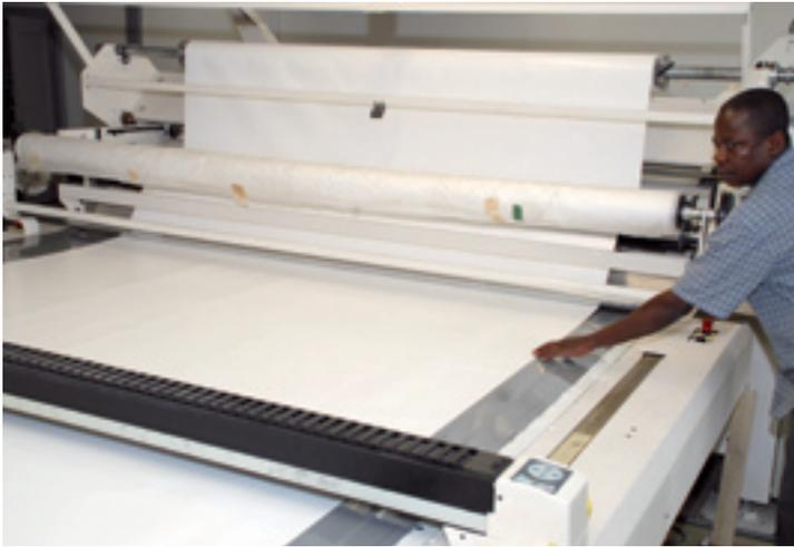
Am 18 Meter langen Schneidetisch entstehen aus Geweberollen die Zelthäute.
