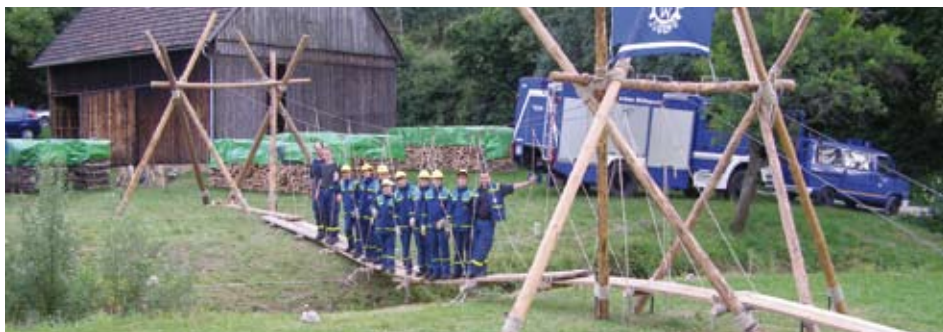
Der Belastungstest: Die 50 Meter lange Hängebrücke hält, was sie verspricht.
