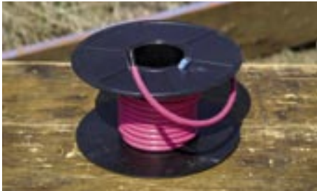
Kein Elektrokabel – ein mit Sprengstoff gefüllter Plastikslauch, die „Sprengschnur“.
