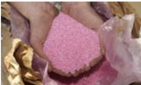
Sprengstoffgranulat auf Basis von Ammoniumnitrat.
