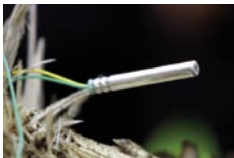
Mit Hilfe einer solchen elektrischen Sprengkapsel wird gezündet.
