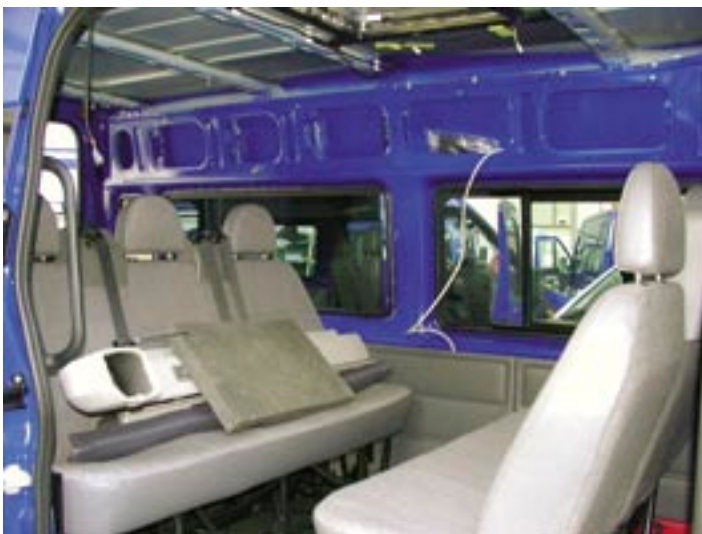
Der Dachhimmel und die Lüftungskanäle müssen zum Einbau der Elektronik abmontiert werden.
