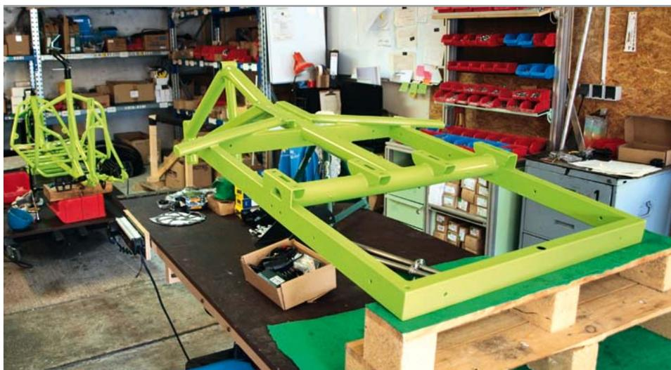
Abbildung 42: Fertigung eines Lastenfahrads
