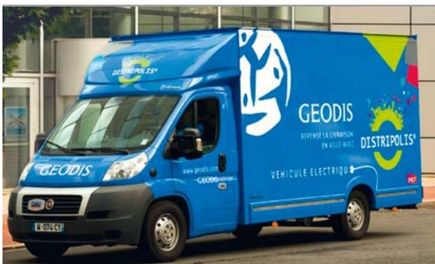
Die für DISTRIPOLIS® eingesetzten batterieelektrischen Transporter „Electron“ wurden von Fraikin und Fiat speziell für die City-Logistik entwickelt. Das zulässige Gesamtgewicht beträgt 3.500 kg bei einer Nutzlast von 1.000 kg. Eine Ladezeit von sechs bis acht Stunden gewährleistet eine Reichweite von 105 bis 155 km bei einer Höchstgeschwindigkeit von 90 km/h. Der Fahrer kann den Laderaum des „Electron“ direkt vom Führerhaus aus betreten und verfügt über eine Ladebordwand für Paletten.
