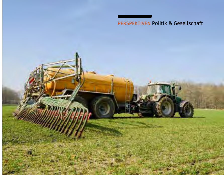
Mit der richtigen Technik bei der Gülleausbringung – hier mittels Schleppschläuchen – lässt sich der Eintrag von Nitrat in Gewässer verringern.
