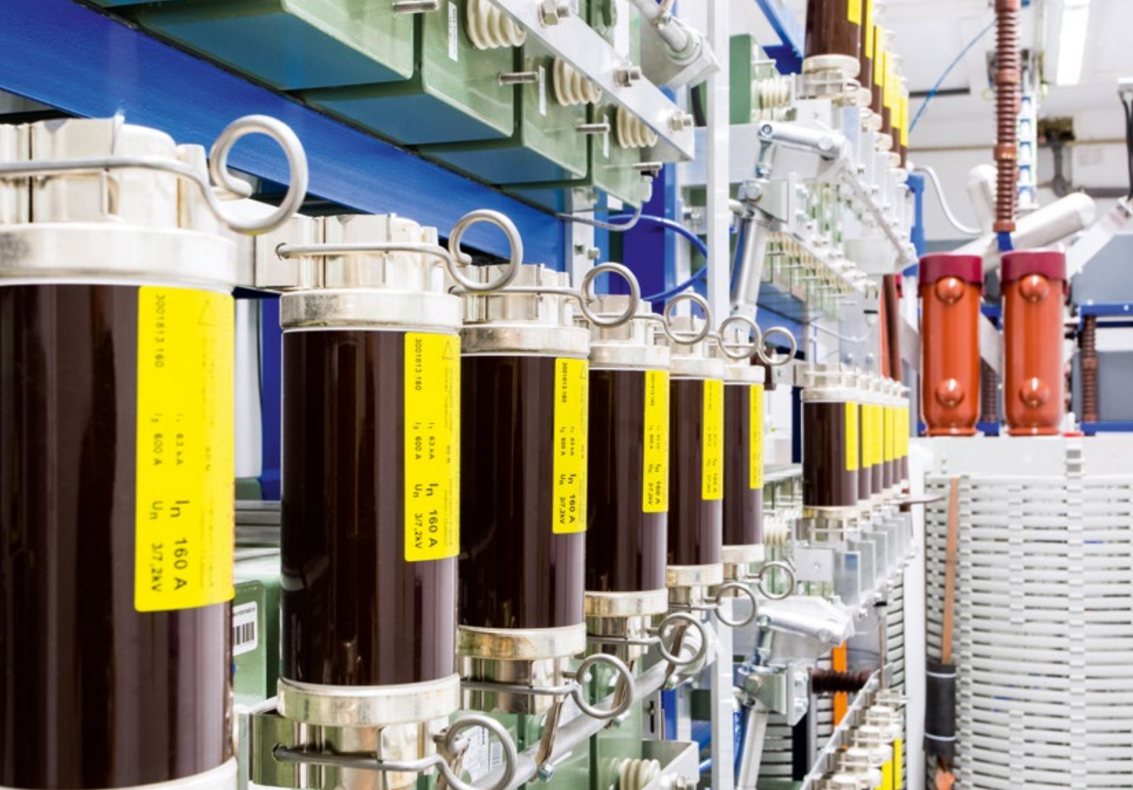
Abbildung 2: Weil-Dobke-Prüfkreis zur synthetischen Leistungsschalterprüfung
