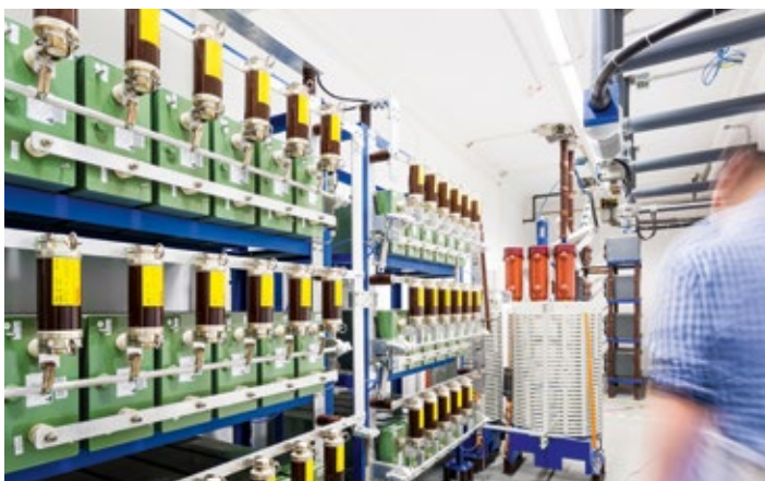
Weil-Dobke-Prüfkreis zur synthetischen Leistungsschalterprüfung
