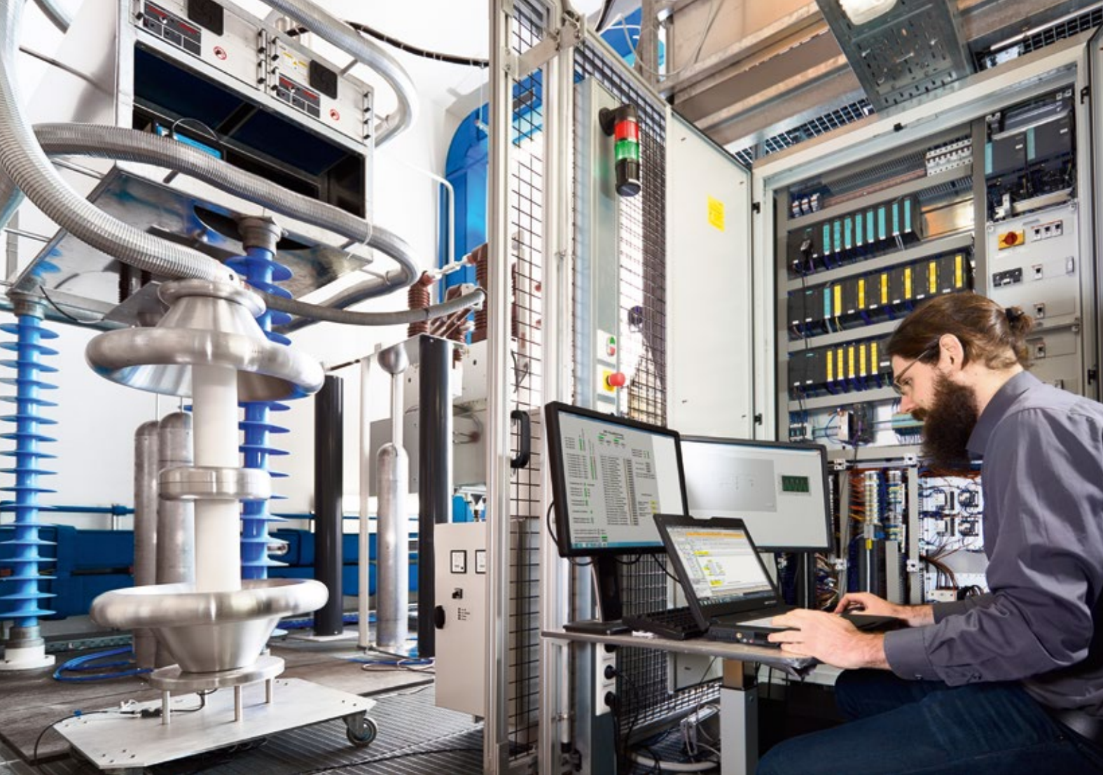
Abbildung 2: Hochspannungsanlage des Prüfkreises
