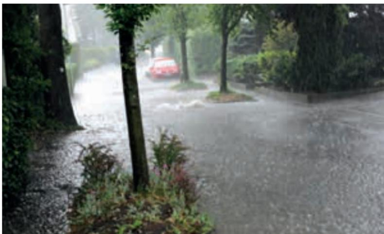
Die großen Niederschlagsmengen können durch die Kanalisation nicht aufgenommen werden. Weil die Oberflächenentwässerung und auch Anlagen zur Regenwasserversickerung versagen, kommt es zu unkontrolliertem Abfluss von Niederschlag, der einzig durch die Geländeform beeinflusst wird. Befinden sich Gebäude im Bereich der Abflüsse, droht Wassereintrag. Überflutungen können an jeder Stelle der Stadt auftreten, also nicht nur in Senken oder in Straßen mit starkem Gefälle.
